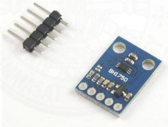
ภาพที่ 2.48 แสดง Light Sensor อุปกรณ์วัดค่าความส่องสว่าง. สืบค้นจาก : http://i.ebayimg.com/00/s/NjAwWDCwMA==/z/YC4AAOxyVLNSp91F/$_35.JPG
