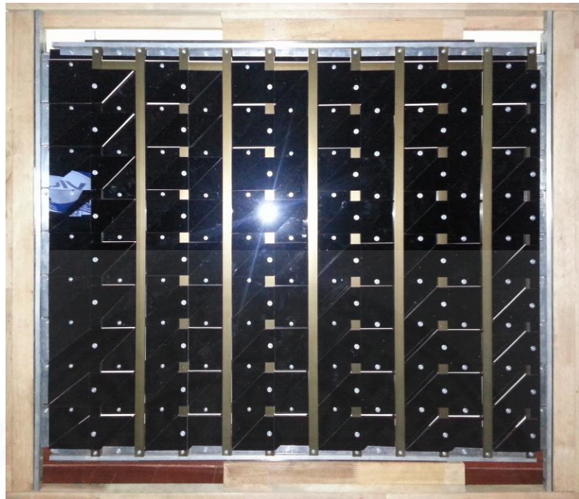
ภาพที่ 3.15 แสดงโครงสร้างที่ใช้เส้นอลูมิเนียมเป็นตัวโครงของแผงกันแดดอัตโนมัติ หมายเหตุ. จากการถ่ายภาพเมื่อวันที่ 26 มิถุนายน พ.ศ. 2557
