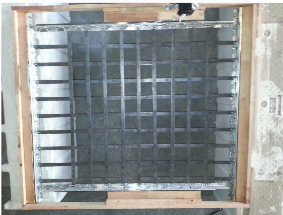
ภาพที่ 3.13 แสดงโครงสร้างที่ใช้เหล็กเป็นตัวโครงของแผงกันแดดอัตโนมัติ หมายเหตุ. จากการถ่ายภาพเมื่อ วันที่ 28 พฤษภาคม พ.ศ. 2557
