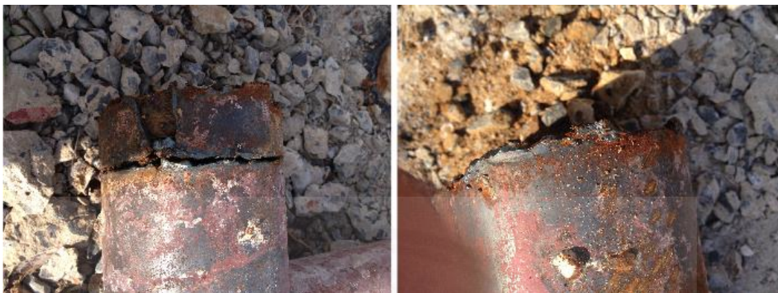
ภาพที่ 4.28 รอยตัดจากเครื่องตัดแก๊ส. จาก ผู้วิจัย, 2556.
