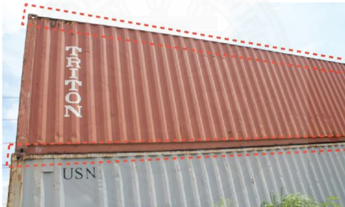
ภาพที่ 4.22 ลักษณะคานของตู้ขนส่งสินค้าแต่ละบริษัท. จาก ผู้วิจัย, 2556.
