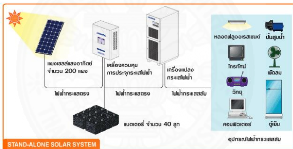
ภาพที่ 4.15 ระบบพลังงานแสงอาทิตย์ชนิดติดตั้งอิสระ (Stand-alone Solar System). จาก Leonics, 2013.
