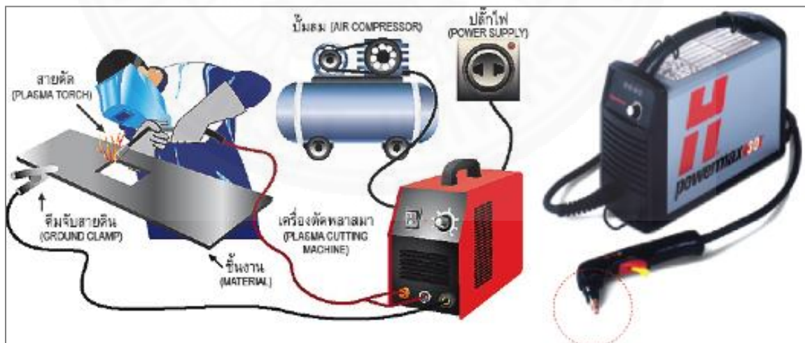
ภาพที่ 4.25 เครื่องตัดพลาสมา. จาก สินสงวนแอนด์ซันส์, 2556.
