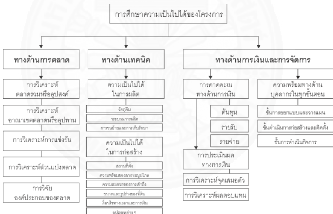
ภาพที่ 3.1 โครงสร้างการศึกษาความเป็นไปได้ของโครงการ. จาก ผู้วิจัย, 2557.
