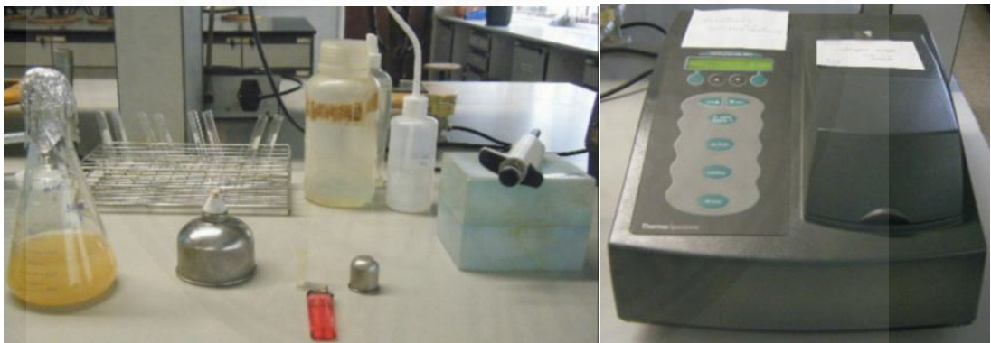
รูปที่ ก2 อุปกรณ์การวัดค่าความขุ่นของเชื้อ S. cerevisiae ที่เพาะเลี้ยงใน Potato dextrose broth ด้วยเครื่อง spectrophotometer
