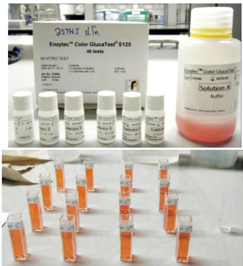
รูปที่ ก19 ชุดทดสอบ Enzytec TM Color Gluca Test ® และการตรวจวัดปริมาณ \beta -glucan ด้วย spectrophotometer
