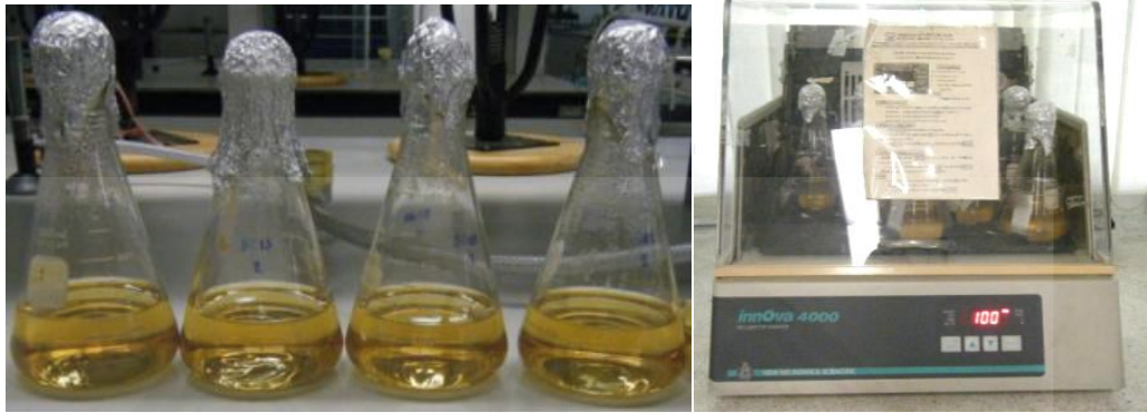
รูปที่ ก1 การเพาะเลี้ยง S. cerevisiae ใน Potato dextrose broth บ่มที่อุณหภูมิ 30 °C เขย่าความเร็ว 100 รอบต่อนาทีด้วยเครื่อง Incubator shaker
