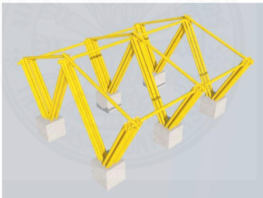
ภาพที่ 4.29 การเพิ่มจำนวนลำไฟในแต่ละชั้นส่วนโครงสร้างของกรอบโครงสร้างรูปแบบที่ 2
