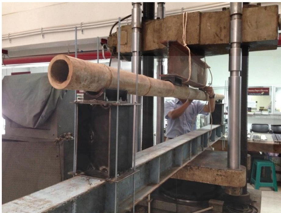
ภาพที่ 3.5 การทดสอบกำลังต้านทานแรงดัด.ภาพถ่ายโดยผู้เขียน, ถ่ายภาพเมื่อวันที่ 2 เมษายน 2557
