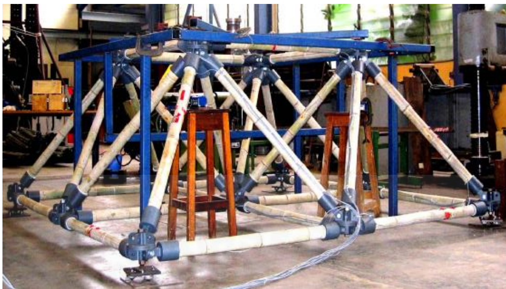
ภาพที่ 2.2 รูปแบบโครงสร้าง double layer grid system. จาก Lightweight bamboo double layer grid system , โดย F. Albermani, G.Y. Goh, S.L. Chan, 2006, Hong Kong.
