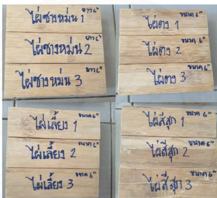
ภาพที่ 2.4 ไม้ไผ่ประกบที่ใช้ในการทดสอบ. จาก การศึกษาคุณสมบัติเชิงกลของวัสดุไม้ประกบที่ทำจากพันธุ์ไม้ไทยเพื่อใช้ออกแบบคานไม้สำหรับอาคารสาธารณะขนาดเล็ก, โดย ชุตินมณฑน์ เสียงสุทธิวงศ์, 2556.
