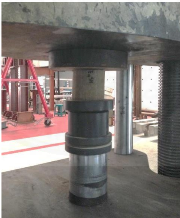
ภาพที่ 3.4 การทดสอบกำลังต้านทานแรงอัด. ภาพถ่ายโดยผู้เขียน, ถ่ายภาพเมื่อวันที่ 11 มีนาคม 2557
