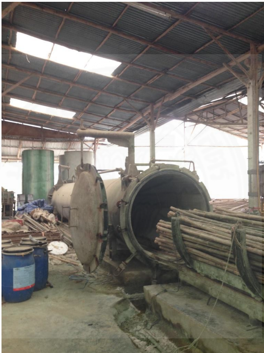
ภาพที่ ค.1 การถนอมไม้ไฟด้วยระบบอัดน้ำยาสุญญากาศ
