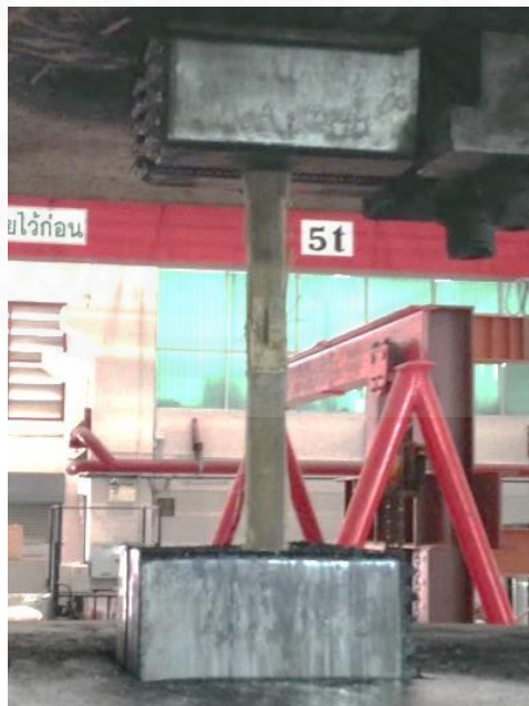
ภาพที่ 3.8 การทดสอบกำลังต้านทานแรงดึง. ภาพถ่ายโดยผู้เขียน, ถ่ายภาพเมื่อวันที่ 14 มีนาคม 2557
