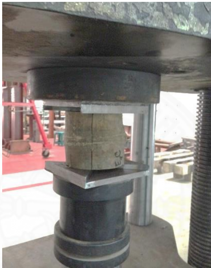
ภาพที่ 3.6 การทดสอบกำลังต้านทานแรงเฉือน. ภาพถ่ายโดยผู้เขียน, ถ่ายภาพเมื่อวันที่ 11 มีนาคม 2557
