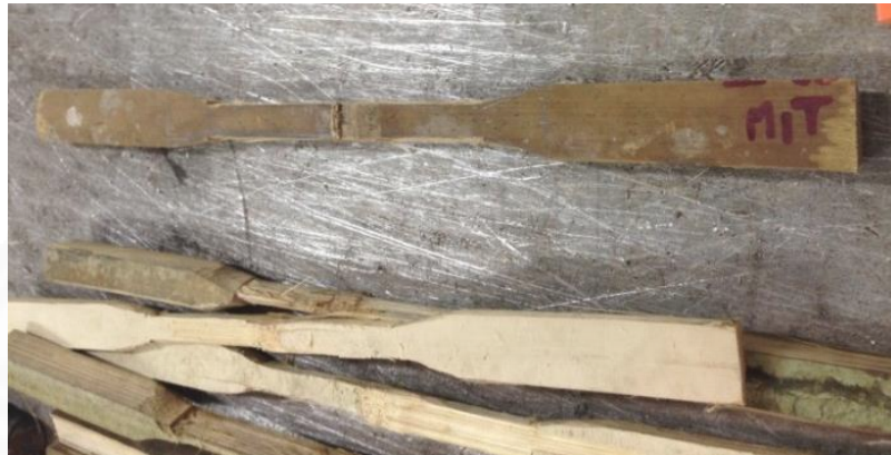
ภาพที่ 3.7 ตัวอย่างไม้ดงในการทดสอบกำลังต้านทานแรงดึง. ภาพถ่ายโดยผู้เขียน, ถ่ายภาพเมื่อวันที่ 14 มีนาคม 2557
