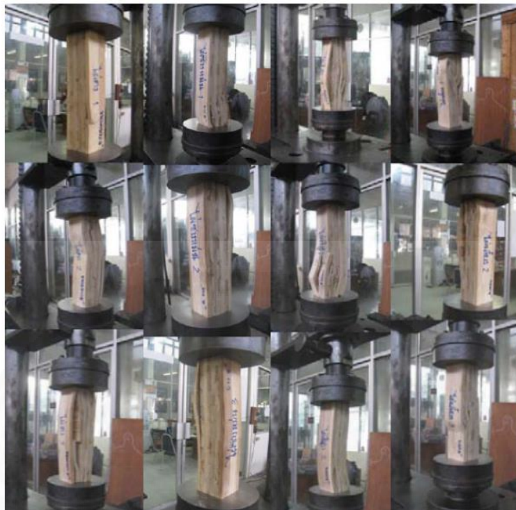
ภาพที่ 2.5 การทดสอบคุณสมบัติเชิงกลของคานไม้ไผ่ประกับ. จาก การศึกษาคุณสมบัติเชิงกลของวัสดุไม้ประกับที่ทำจากพันธุ์ไม้ไทยเพื่อใช้ออกแบบคานไม้สำหรับอาคารสาธารณะขนาดเล็ก, โดย ชุตินมพันธ์ เสียงสุทธีวงศ์, 2556.
