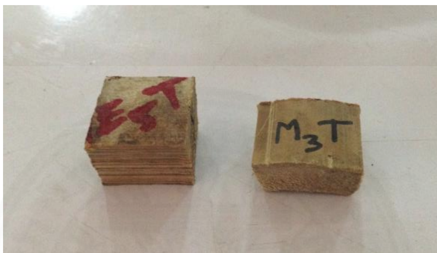
ภาพที่ 3.2 ตัวอย่างไม้ต่งในการทดสอบความชื้น. ภาพถ่ายโดยผู้เขียน, ถ่ายภาพเมื่อวันที่ 11 มีนาคม 2557
