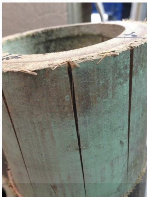
ภาพที่ ค.3 ลักษณะของไผ่ตงหลังจากการทดสอบกำลังต้านทานแรงอัด (Compression)
