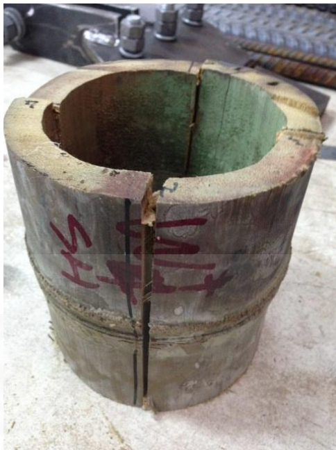
ภาพที่ ค.4 ลักษณะของไม้ตงหลังจากการทดสอบกำลังต้านทานแรงเฉือน (Shear)
