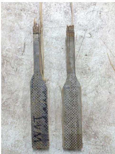
ภาพที่ ค.5 ลักษณะของไม้ตงหลังจากการทดสอบกำลังต้านทานแรงดึง (Tension)
