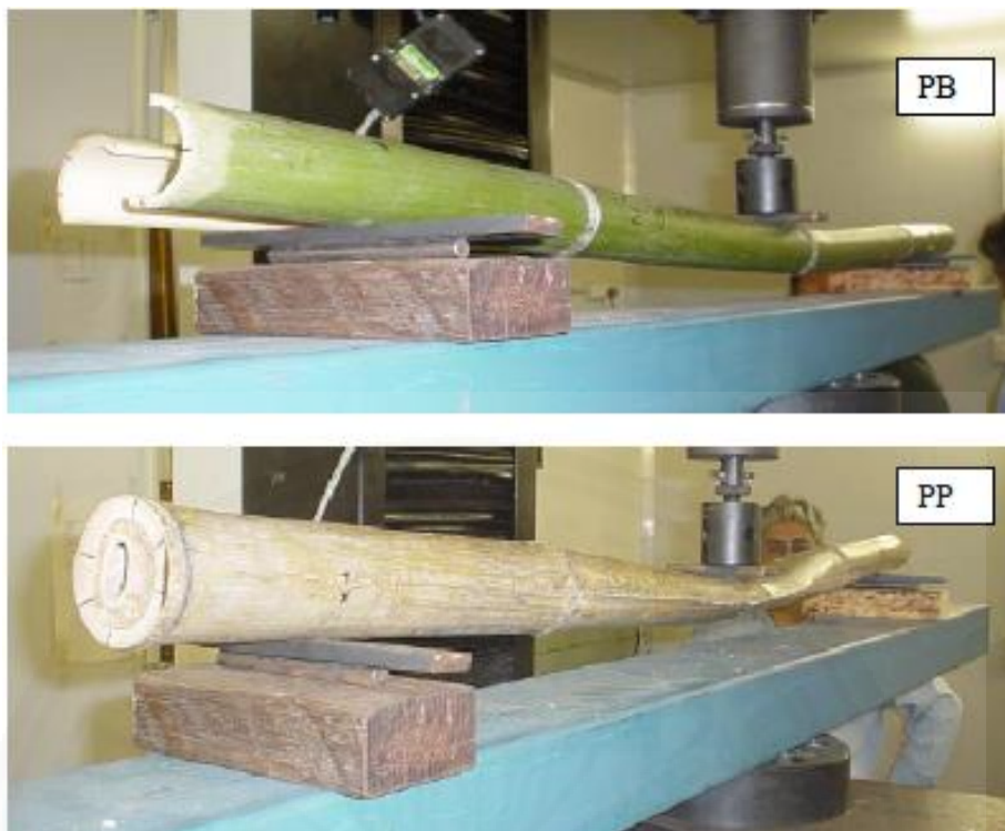
ภาพที่ 2.1 การทดสอบคุณสมบัติเชิงกลของไม้ Phyllostachy Bambusoides (PB) และ Phyllostachy Pubescens (PP). จาก Lightweight bamboo double layer grid system , โดย F.Albermani,G.Y. Goh, S.L. Chan, 2006, Hong Kong.
