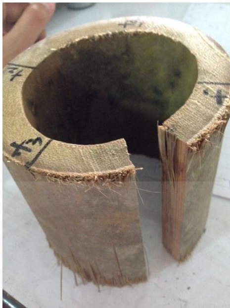
ภาพที่ ค.2 ลักษณะของไผ่ตงหลังจากการอบเพื่อหาค่าการหดตัว
