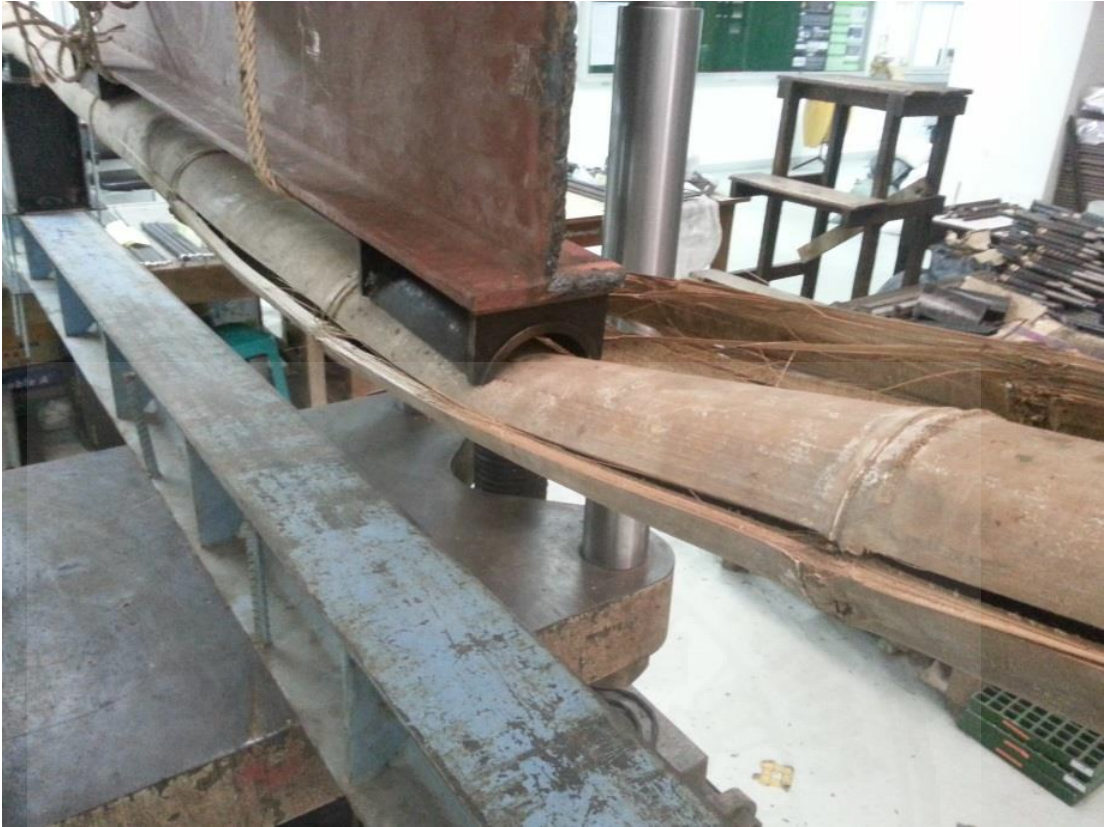
ภาพที่ ค.6 ลักษณะของไม้ตงหลังจากการทดสอบกำลังต้านทานแรงดัด (Bending)
