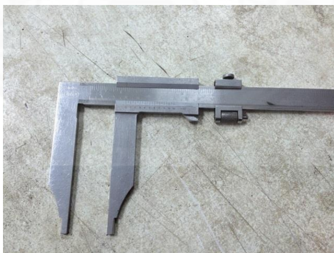
ภาพที่ ข.2 เครื่องมือวัด Vernier Caliper
