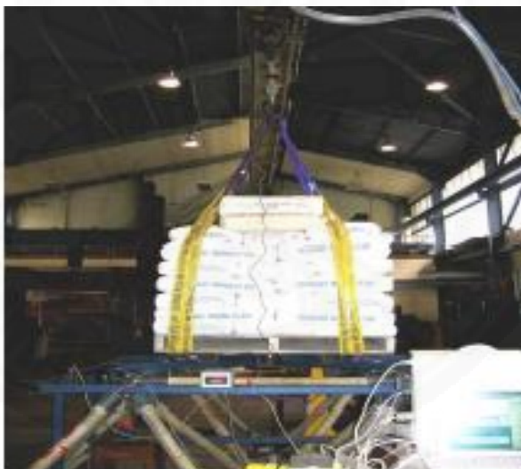
ภาพที่ 2.3 การทดสอบการรับน้ำหนักของโครงสร้างแบบ double layer grid system. จาก Lightweight bamboo double layer grid system , โดย F. Albermani, G.Y. Goh, S.L. Chan, 2006, Hong Kong.
