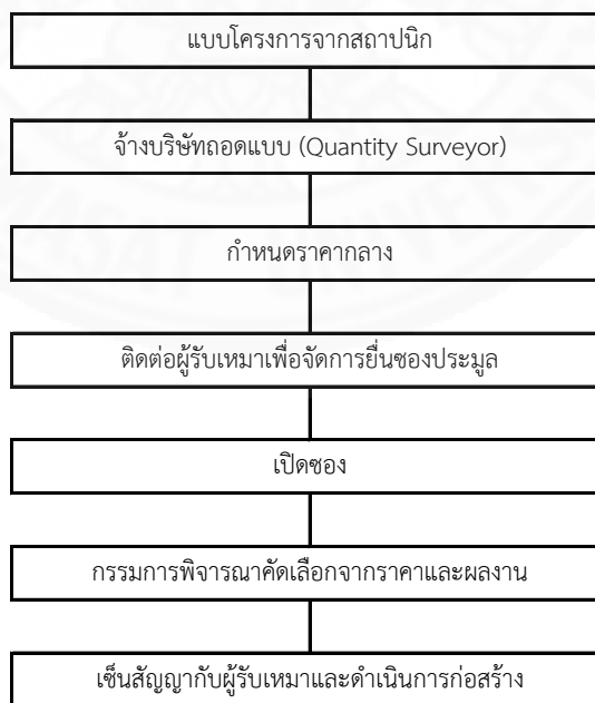
ภาพที่ 6-1 ขั้นตอนการจัดประมูลของผู้รับเหมาก่อสร้าง
