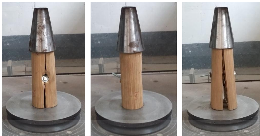
ภาพที่ 4.4 ลักษณะการวิบัติของข้อต่อแบบกรวยมีสลักเกลียว
