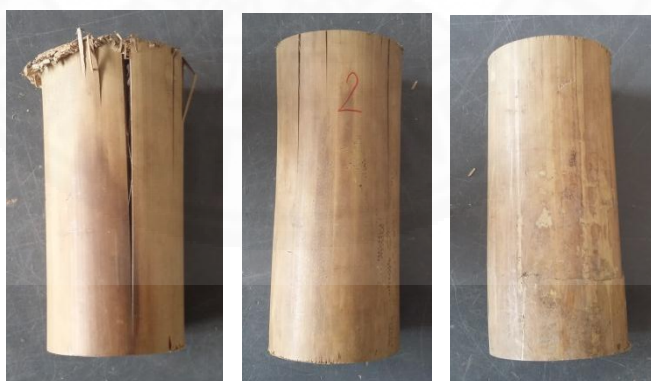
ภาพที่ 4.1 ลักษณะการวิบัติของลำไม้
