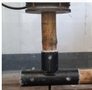
ภาพที่ 4.9 ลักษณะการวิบัติของข้อต่อแบบท่อโดยมีการใส่ฮีฟ็อกซีผสมทรายหยาบและสลักเกลียว
