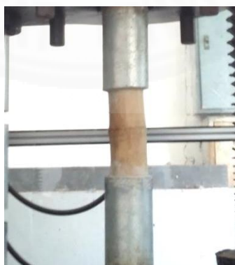
ภาพที่ 4.15 ลักษณะการวิบัติของข้อต่อแบบท่อโดยมีการใส่ฮีฟ็อกซี 10 เซนติเมตร ผสมกับทรายหยาบเบอร์ 50 และทำผิวไม้ขรุขระและใส่สลักเกลียว
