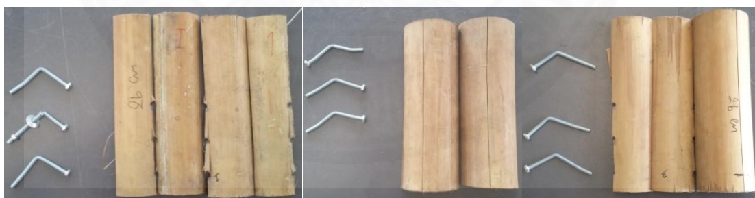
ภาพที่ 4.5 ลักษณะการวิบัติของข้อต่อแบบแผ่นเหล็ก
