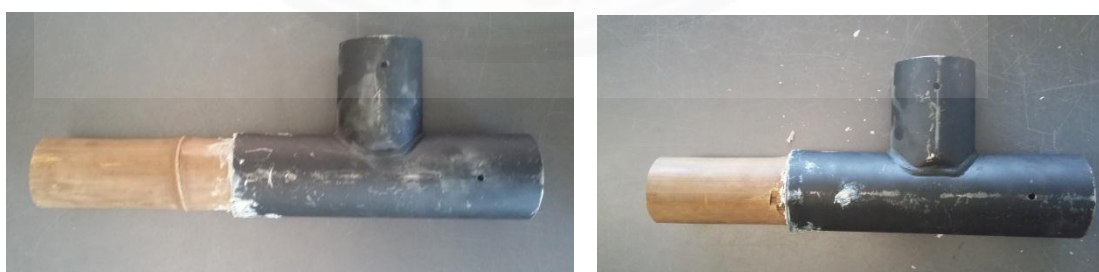
ภาพที่ 4.7 ลักษณะการวิบัติของข้อต่อแบบท่อโดยมีการใส่ฮีฟ็อกซี
