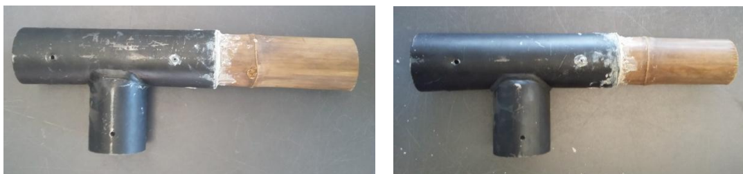
ภาพที่ 4.8 ลักษณะการวิบัติของข้อต่อแบบท่อโดยมีการใส่ฮีฟ็อกซีและสลักเกลียว
