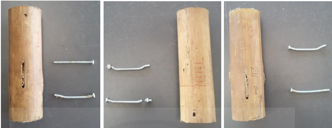
ภาพที่ 4.2 ลักษณะการวิบัติของข้อต่อแบบท่อ
