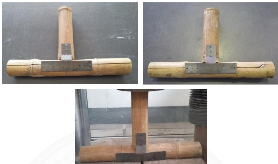
ภาพที่ 4.6 ลักษณะการวิบัติของข้อต่อแบบแผ่นเหล็กตัวที่
