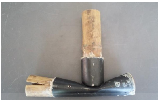
ภาพที่ 4.10 ลักษณะการวิบัติของข้อต่อแบบท่อโดยมีการใส่ฮีฟ็อกซีผสมทรายหยาบและสลักเกลียว
