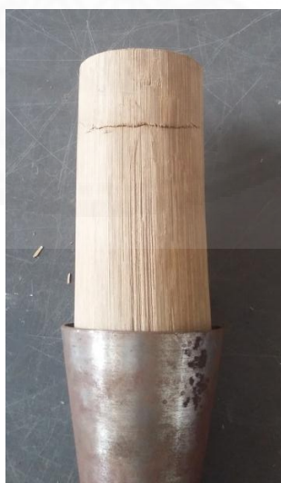
ภาพที่ 4.3 ลักษณะการวิบัติของข้อต่อแบบกรวยไม่มีสลักเกลียว
