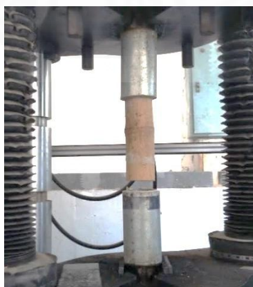
ภาพที่ 4.13 ลักษณะการวิบัติของข้อต่อแบบท่อโดยมีการใส่ฮีฟ็อกซี 5 เซนติเมตร
