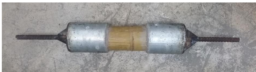
ภาพที่ 4.14 ลักษณะการวิบัติของข้อต่อแบบท่อโดยมีการใส่ฮีฟ็อกซี่ 10 เซนติเมตร ผสมกับทราย หยาบเบอร์ 50 และทำผิวไม้ขรุขระ
