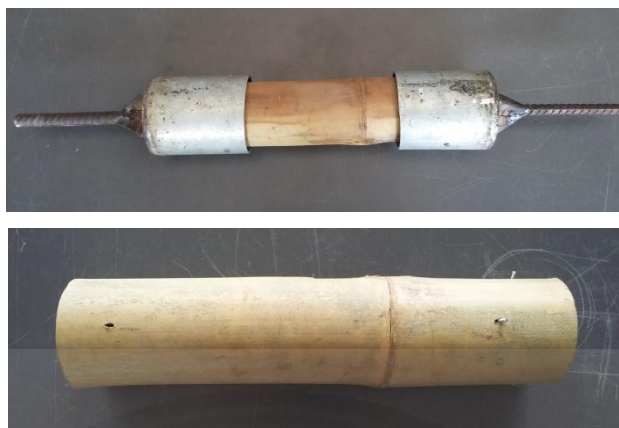
ภาพที่ 4.12 ลักษณะการวิบัติของข้อต่อแบบท่อโดยใช้สลักเกลียว
