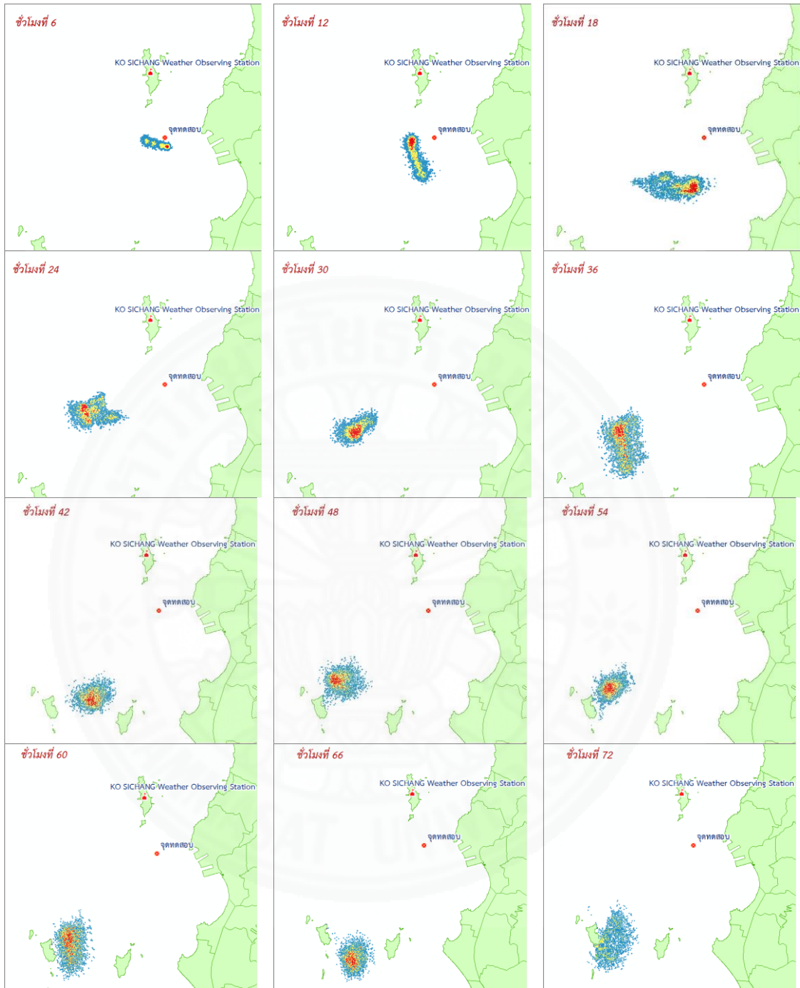
ภาพที่ 6ค ผลการวิเคราะห์ความหนาแน่นการกระจายตัวเชิงพื้นที่ของคราบน้ำมัน ช่วงน้ำตาย ช่วงเปลี่ยนฤดูมรสุมครั้งที่ 1
