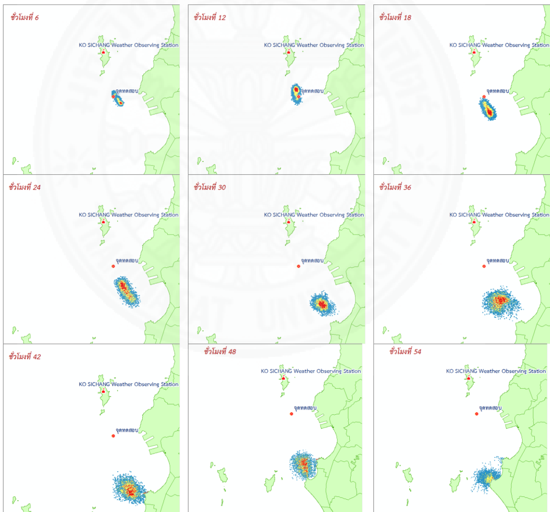
ภาพที่ 5ค ผลการวิเคราะห์ความหนาแน่นการกระจายตัวเชิงพื้นที่ของคราบน้ำมัน ช่วงน้ำตาย ฤดูมรสุมตะวันออกเฉียงเหนือ
