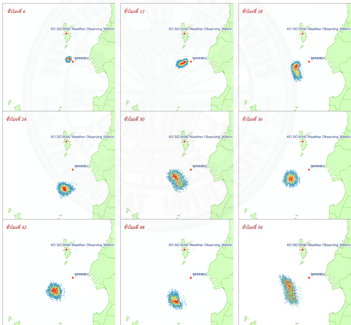
ภาพที่ 1ค ผลการวิเคราะห์ความหนาแน่นการกระจายตัวเชิงพื้นที่ของคราบน้ำมัน ช่วงน้ำเป็น ฤดูมรสุมตะวันออกเฉียงเหนือ
