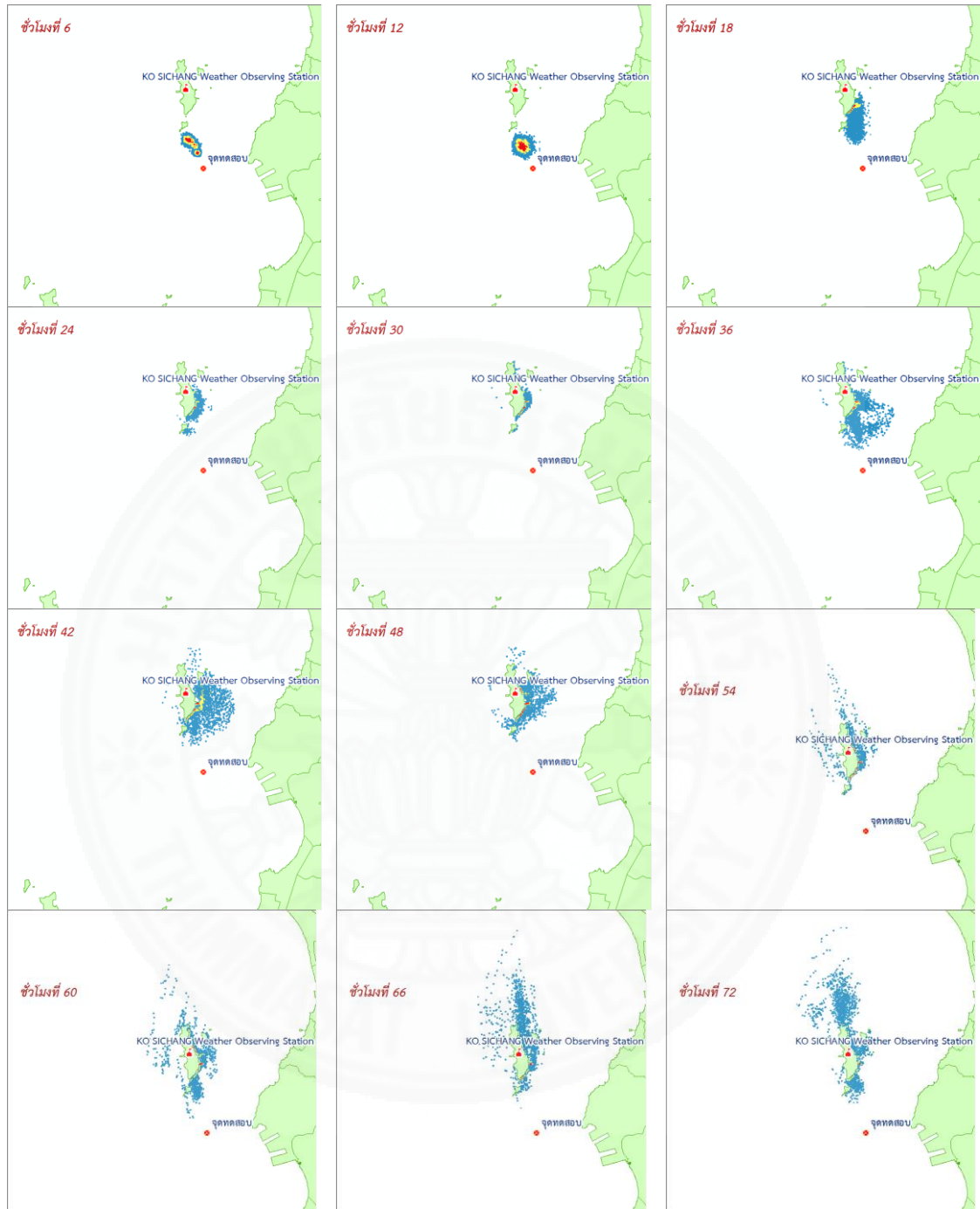
ภาพที่ 2ค ผลการวิเคราะห์ความหนาแน่นการกระจายตัวเชิงพื้นที่ของคราบน้ำมัน ช่วงน้ำเป็น ช่วงเปลี่ยนฤดูมรสุมครั้งที่ 1
