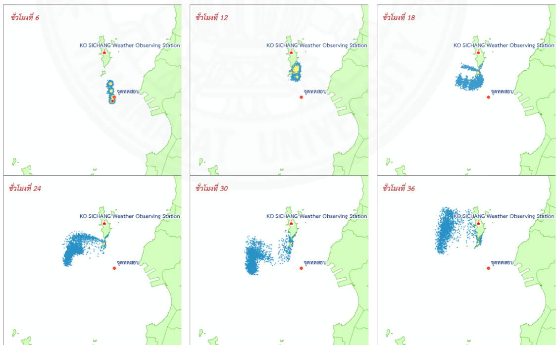
ภาพที่ 8ค ผลการวิเคราะห์ความหนาแน่นการกระจายตัวเชิงพื้นที่ของคราบน้ำมัน ช่วงน้ำตาย ช่วงเปลี่ยนฤดูมรสุมครั้งที่ 2
