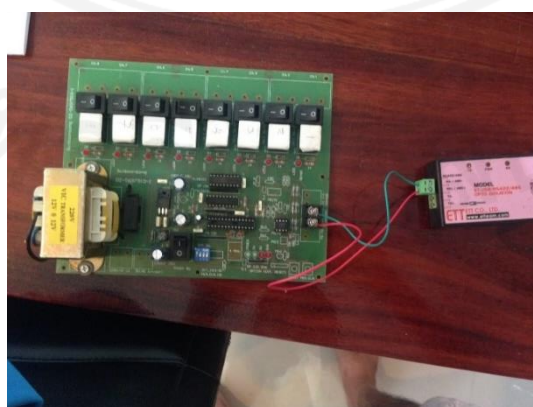
ภาพที่ 4.7 การเชื่อมต่อระหว่างตัวแปลงสัญญาณและบอร์ดรีเลย์
