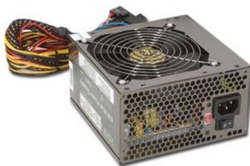
ภาพที่ 4.7 ระบบจ่ายไฟที่ใช้ในคอมพิวเตอร์ทั่วไป ขนาดมาตรฐานเอทีเอ็กซ์
