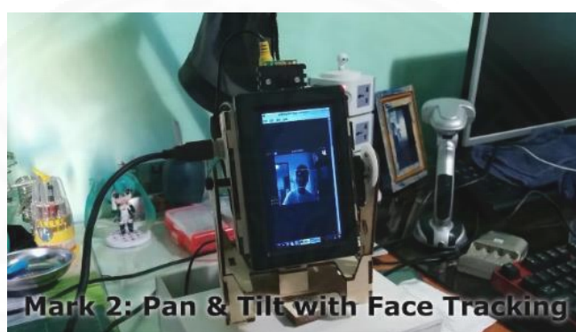
ภาพที่ 4.18 การทดลองการตรวจจับและติดตามใบหน้าด้วยการดึงประสิทธิภาพบางส่วนจากหน่วยประมวลผลภาพ
