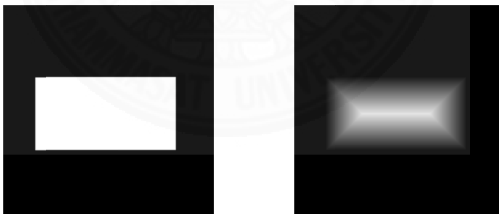
ภาพที่ 2.4 (ด้านซ้าย) ภาพวัตถุเริ่มต้น (ด้านขวา) ภาพผลลัพธ์จากการทำ Distance Transform โดยใช้การวัดระยะทางจริง (Euclidian Distance)
