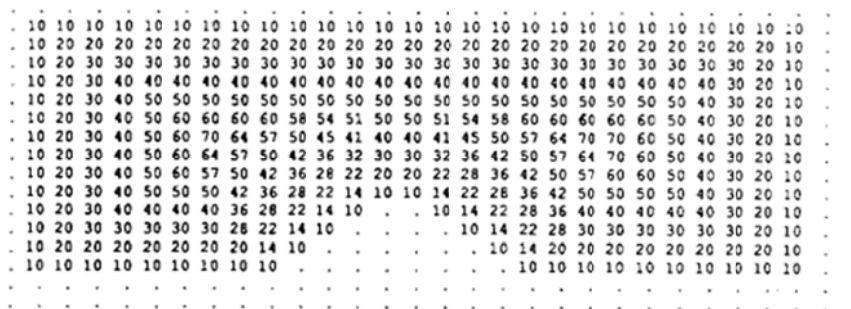
ภาพที่ 2.10 ข้อมูลDistance Transform โดยใช้ตารางระยะทาง จากภาพที่ 2.9 จาก (Shih, F. Y and Pu C. C, 1990)
