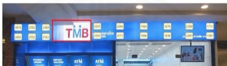
ภาพที่ 3.7 การกำหนดจุดการตรวจวัดค่าความส่องสว่างไฟฟ้าภายในป้ายธนาคาร
