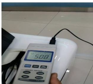
ภาพที่ 3.6 การวัดค่าความส่องสว่างระบบไฟฟ้าแสงสว่างในแต่ละพื้นที่ภายในธนาคาร
