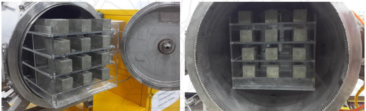
ภาพที่ 4.18 ลักษณะการวางซีเมนต์เพสต์แบบ 24 ก้อน ภายในควิวตี้
