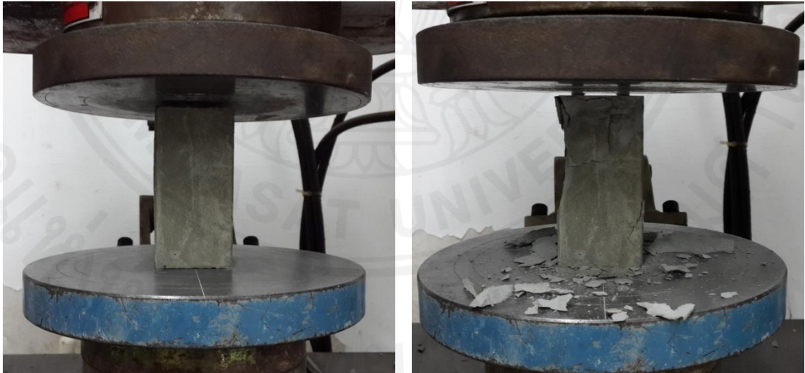
ภาพที่ 4.20 ภาพก่อนและหลังการทดสอบกำลังอัดของซีเมนต์เพสต์
