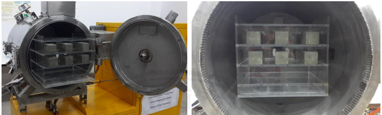
ภาพที่ 4.17 ลักษณะการวางซีเมนต์เพสต์แบบ 12 ก้อน ภายในควิวตี้
