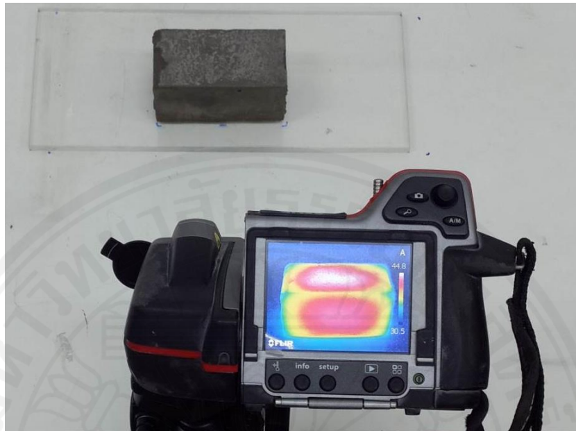
ภาพที่ 4.19 การถ่ายภาพการกระจายตัวของความร้อนที่ผิวซีเมนต์เพสต์
