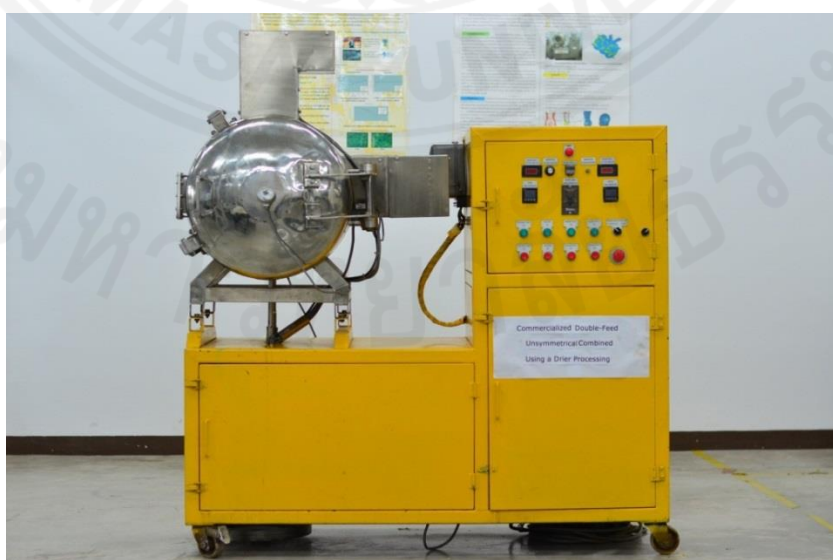
ภาพที่ 4.1 เครื่องไมโครเวฟป้อนคลื่นสองตำแหน่งแบบไม่สมมาตรร่วมกับระบบสุญญากาศ
