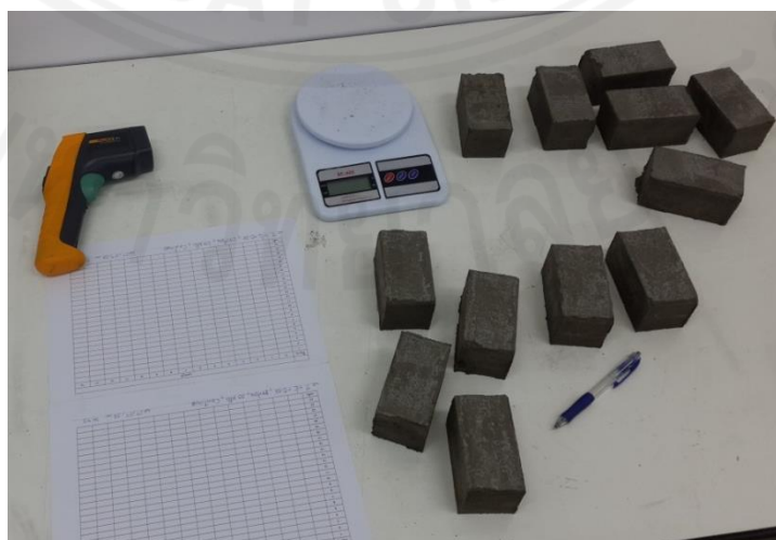
ภาพที่ 4.16 การชั่งน้ำหนักเริ่มต้นและอุณหภูมิเริ่มต้นของซีเมนต์เพสต์
