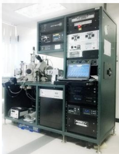
ภาพที่ 3.2 ระบบสปัตเตอริงรุ่น AJA INTERNATIONAL, ATC 2000-F แบบ 3 หัว
