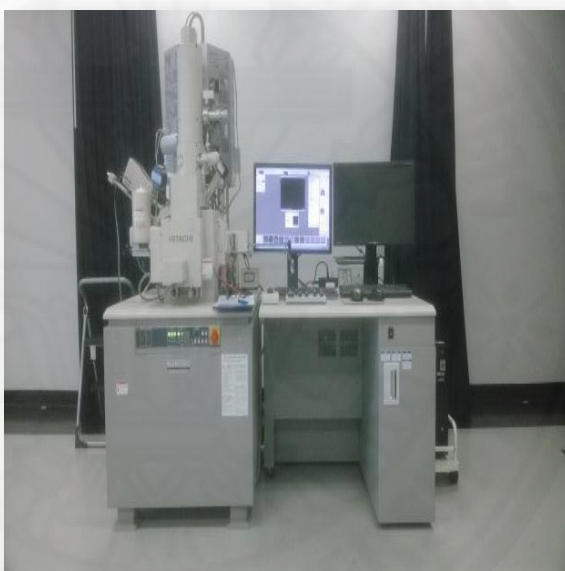
ภาพที่ 3.9 กล้องจุลทรรศน์อิเล็กตรอนแบบส่องกราดชนิด Field Emission (FE-SEM), Hitachi รุ่น S4700
