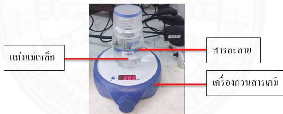
ภาพที่ 3.4 กวนสารละลายให้เป็นสารละลายเนื้อเดียวกัน
