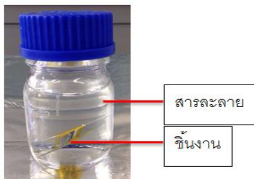
ภาพที่ 3.5 เตรียมชิ้นงานลงบนกระจกสไลด์และจุ่มลงในสารละลาย
