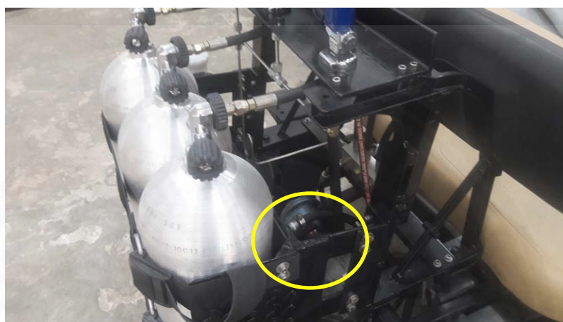
ภาพที่ 2.16 ตำแหน่งติดตั้งเครื่องยนต์ลมอัด
