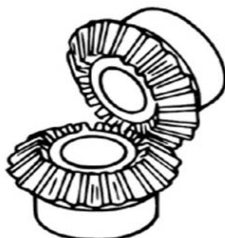
ภาพที่ 2.12 เฟืองดอกจอก (Bevel gears)
