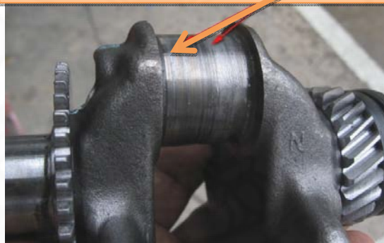
ภาพที่ 4.3 เพลาข้อเหวี่ยงที่เกิดรอยไหม้และร่องรอยเกิดความเสียหาย
