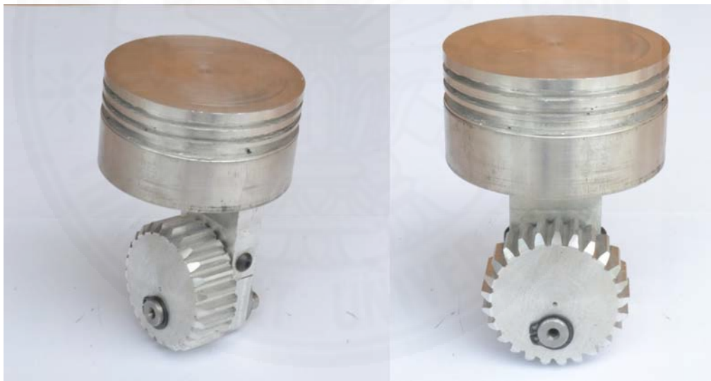
ภาพที่ 4.19 ก้านลูกสูบยึดติดกับลูกสูบแบบคงที่
