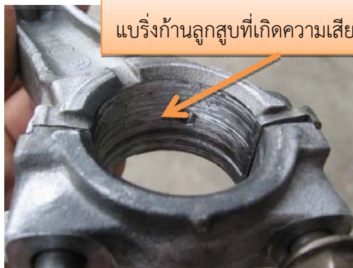
ภาพที่ 4.4 แบริ่งก้านลูกสูบที่เกิดความเสียหายจากเพลาข้อเหวี่ยง
