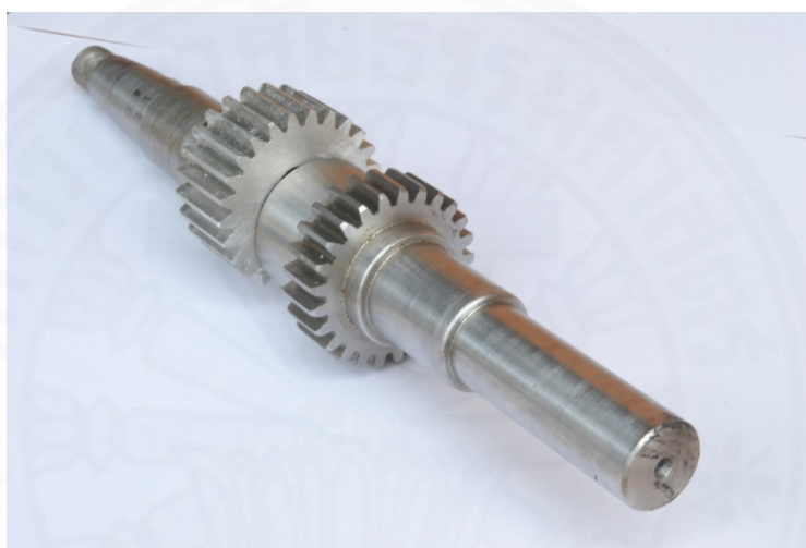
ภาพที่ 4.16 เพลาข้อเหวี่ยงแบบฟันเฟืองเยื้องศูนย์
