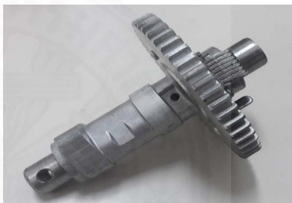
ภาพที่ 4.8 ชุดเพลาราวลิ่งทำหน้าที่ ปิด-เปิด วาล์วไอดีและวาล์วไอเสีย
