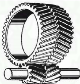
ภาพที่ 2.11 เฟืองก้างปลา (Herringbone gears)
