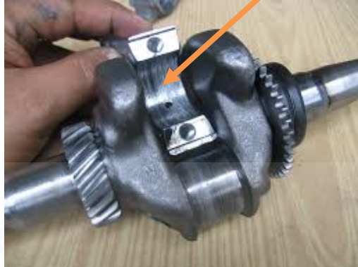
ภาพที่ 4.2 แบริ่งเพลาข้อเหวี่ยงที่เกิดความเสียหายจากการหนีศูนย์กลางของเพลา
