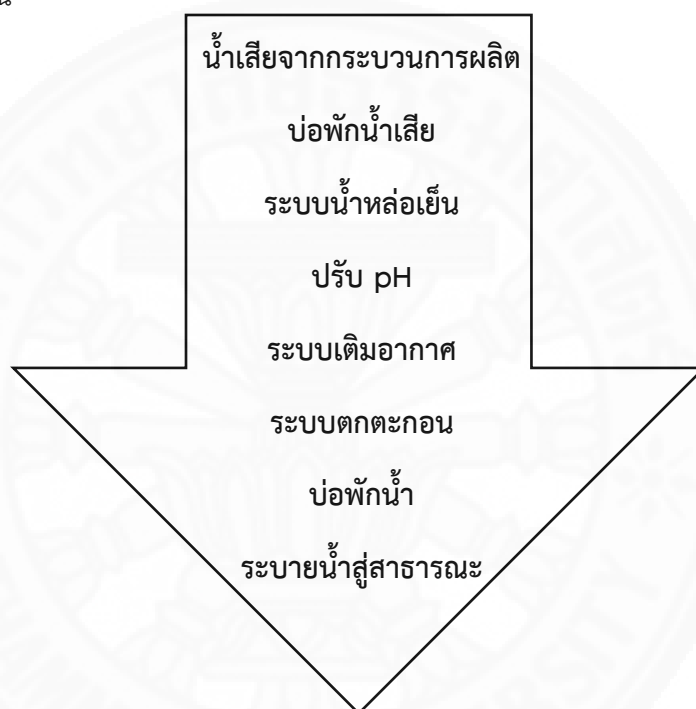
ภาพที่ 4.19 กระบวนการบำบัดน้ำเสียจากระบบบำบัดน้ำเสียของโรงงานจงสถิตย์ จำกัด
