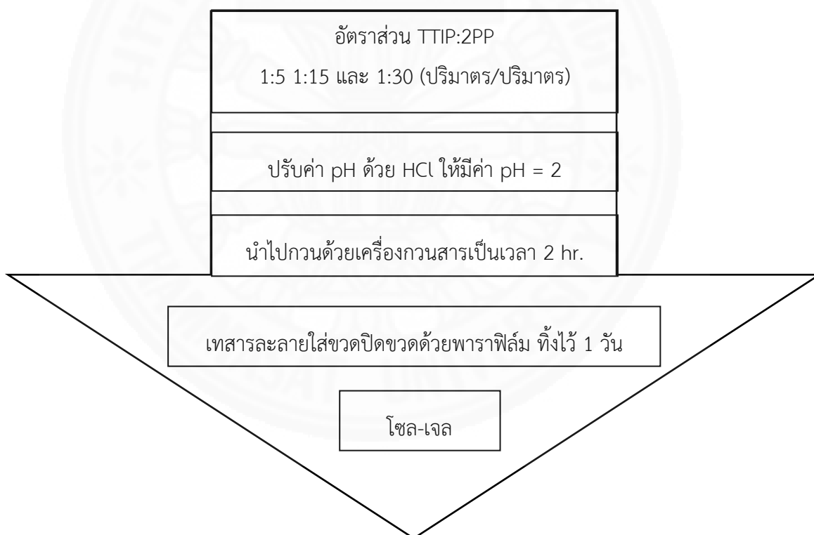
ภาพที่ 3.5 ขั้นตอนการเตรียมโซล-เจล
