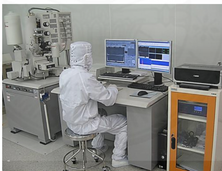
ภาพที่ 3.4 การวิเคราะห์โครงสร้างจุลภาคด้วยเครื่อง FE-SEM
