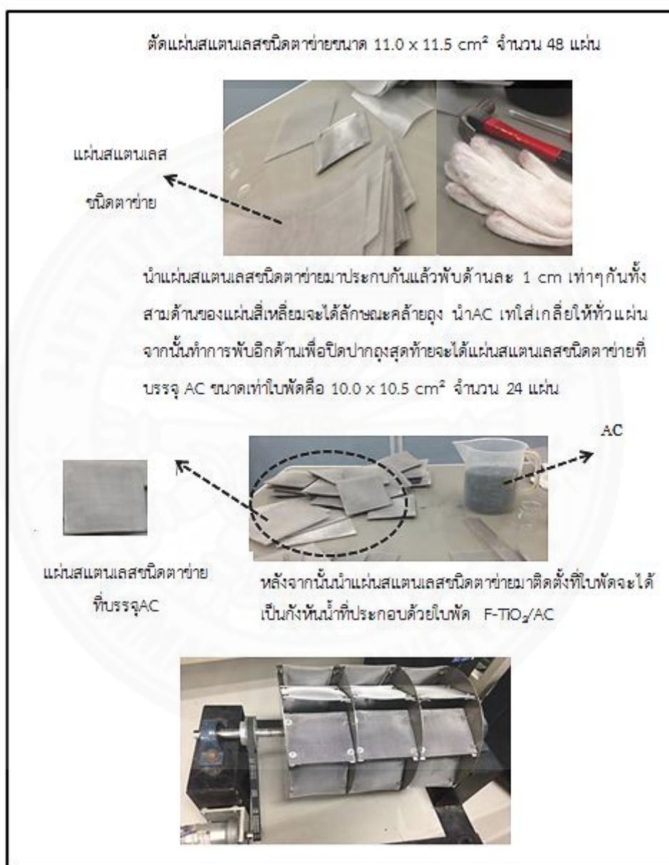
ภาพที่ 3.12 การประกอบกังหันน้ำที่ประกอบด้วยใบพัด \text{F-TiO}_2/\text{AC}
