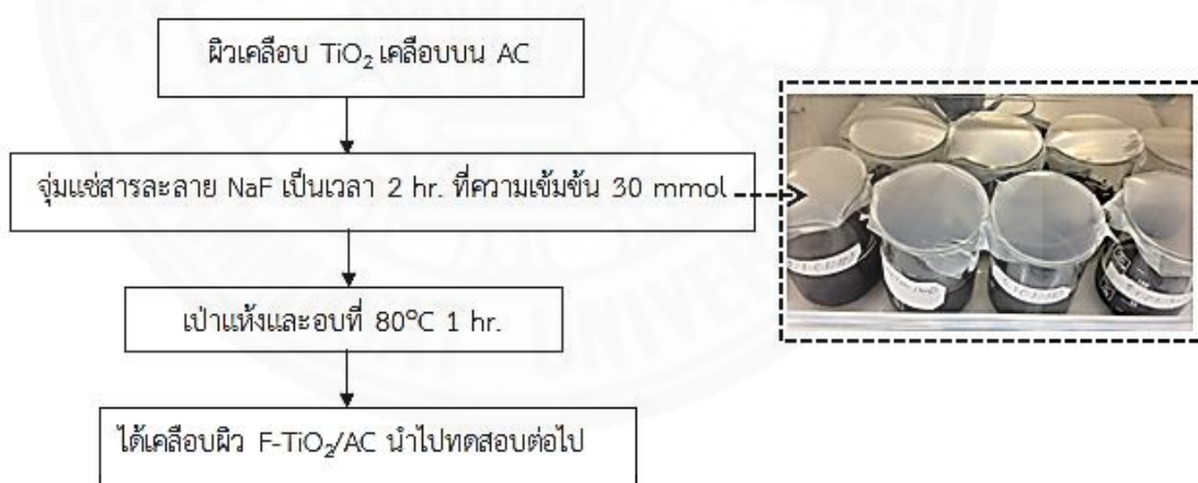
ภาพที่ 3.10 ขั้นตอนการเติมฟลูออรีนลงบน \text{TiO}_2/\text{AC} เพื่อสร้างตัวอย่าง F- \text{TiO}_2/\text{AC}
