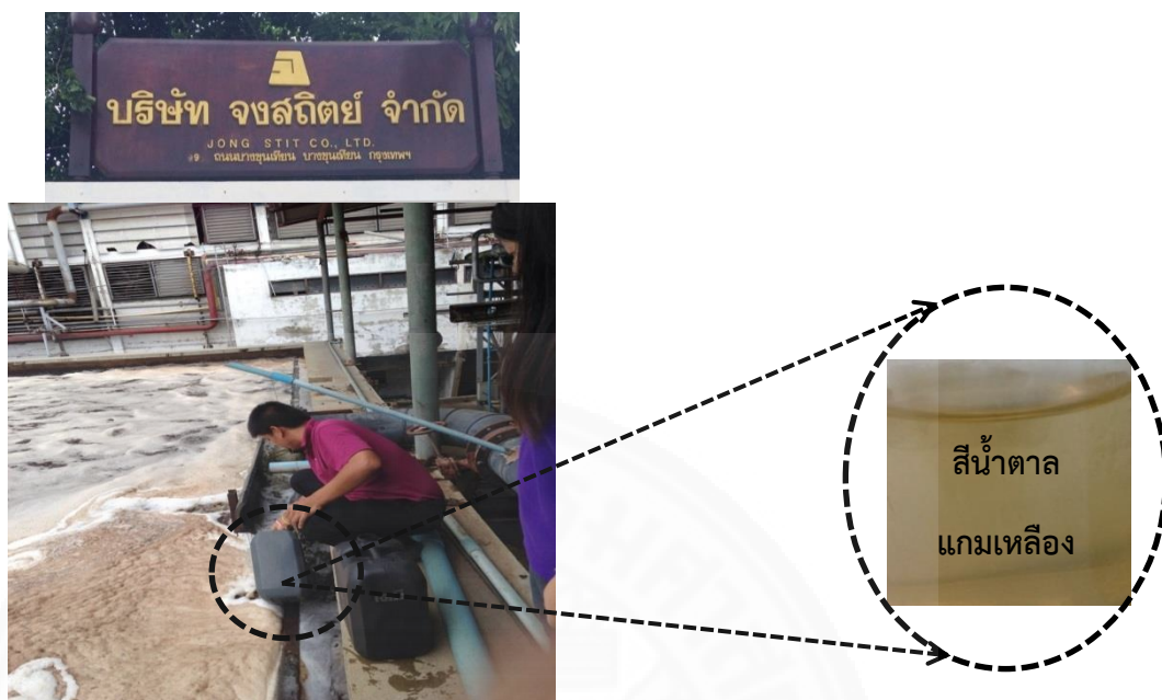
ภาพที่ 4.20 ลักษณะน้ำเสียจากระบบหล่อเย็นของโรงงานอุตสาหกรรมสิ่งทอ
