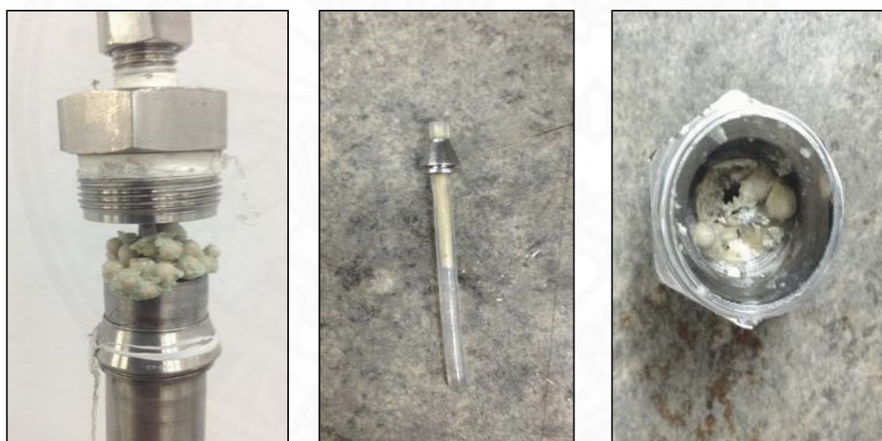
ภาพที่ 4.7 การอุดตันในเครื่องปฏิกรณ์ และท่อของผลิตภัณฑ์สารประกอบคีโตนที่เกิดขึ้นจากการเกิดปฏิกิริยาคีโตเนเซชัน
