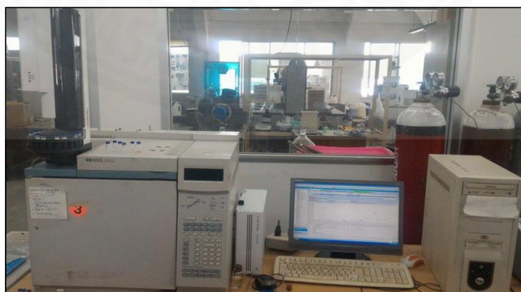
ภาพที่ 2.11 เครื่องวิเคราะห์แก๊สโครมาโทกราฟฟี ยี่ห้อ HEWLETT PACKARD รุ่น HP6890 ที่ติดตั้งด้วยคอลัมน์ชนิด DB-1
