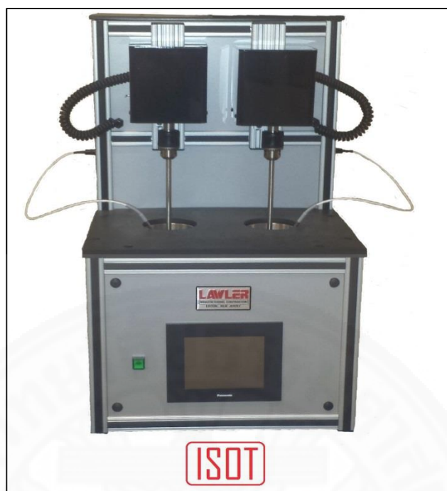
ภาพที่ 2.2 เครื่องมือทดสอบการเกิดออกซิเดชันของน้ำมันหล่อลื่น (Indiana Stirring Oxidation Tester, ISOT)
