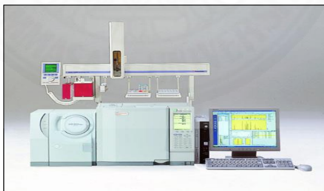
ภาพที่ 2.12 เครื่องวิเคราะห์แก๊สโครมาโตกราฟี – แมสเปกโตรเมตรี ยี่ห้อ SHIMADZU รุ่น QO-2010 Ultra
