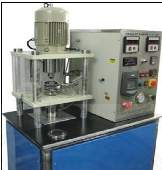
ภาพที่ 2.4 เครื่องมือทดสอบการป้องกันการสึกหรอ และการรับแรงกด (Anti Wear) 4-Ball Wear และ 4-Ball EP
