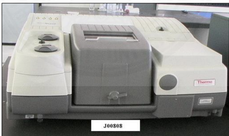
ภาพที่ 2.13 เครื่องวิเคราะห์สารด้วยอินฟราเรด ยี่ห้อ Thermo รุ่น 470 FT-IR
