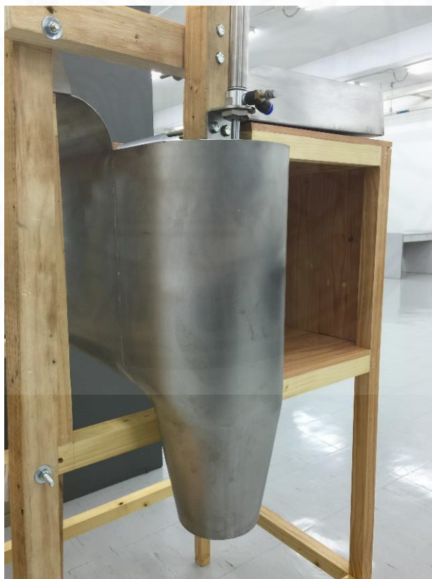
ภาพที่ 4.30 ทรงกระบอกเรียวขณะเตรียมกดบรรจุก้อนเส้นด้านหน้า
