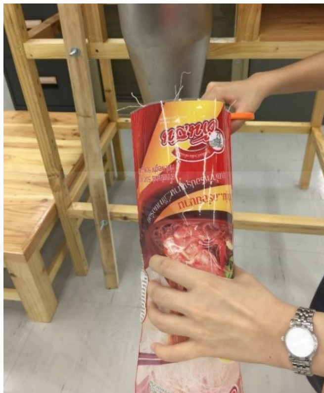
ภาพที่ 4.32 ตัดแต่งจุกเส้นส่วนเกินและตรวจสอบความเรียบร้อย
