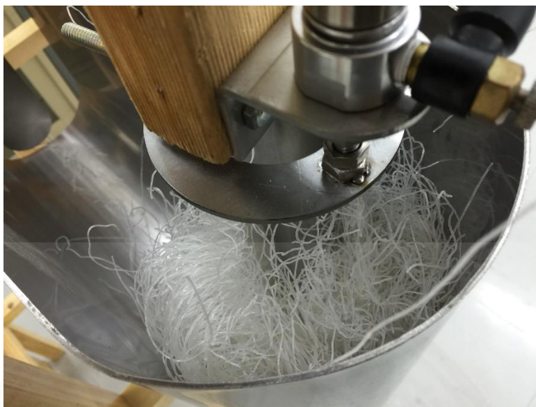
ภาพที่ 4.29 ทรงกระบอกเรียวขณะเตรียมกดบรรจุก้อนเส้น
