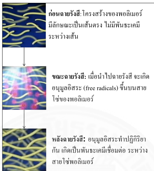
ภาพที่ 2.14 กลไกการเกิดปฏิกิริยาการเชื่อมโยงระหว่างโมเลกุล โดยการฉายรังสี (ดัดแปลงจาก http://www0.tint.or.th/nkc/nkc5003/nkc5003f.html )
