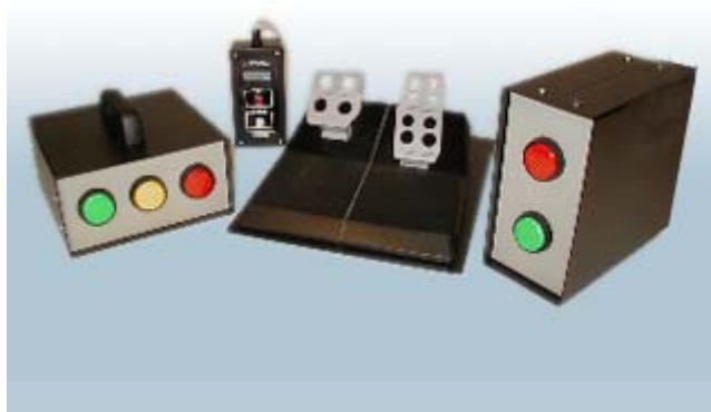
ภาพที่ 2.19 เครื่องทดสอบ RT-2s Brake Reaction time ผลิตโดย Therapy Products, Inc ที่มา http://www.atpwork.com/images/pdfs/ReactionTimer.pdf
