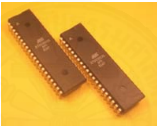
ภาพที่ 3.6 ลักษณะภายนอกของไมโครคอนโทรลเลอร์ AT90S8535 แบบ DIP 40 ขา
