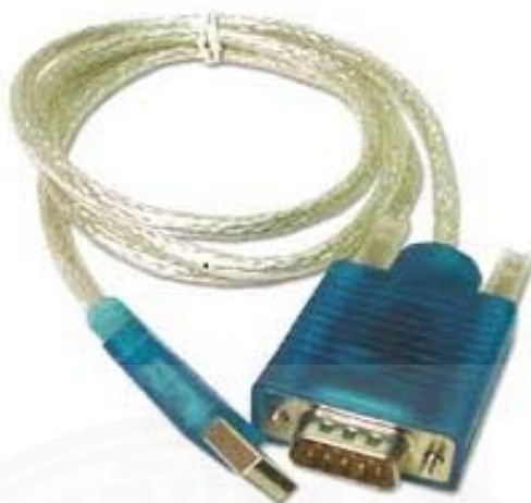
ภาพที่ 3.23 อุปกรณ์ แปลงจาก USB Port เป็น Serial Port
