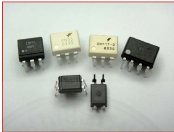
ภาพที่ 3.24 ตัวอย่างอุปกรณ์เชื่อมต่อทางแสงที่ใช้ตัวถังแบบต่างๆ
