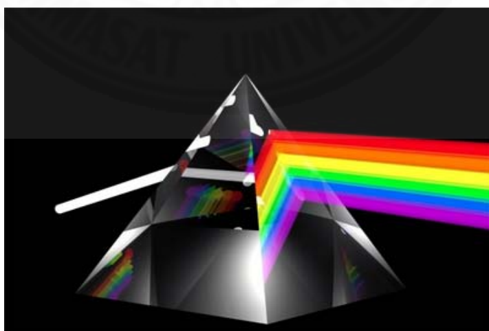
ภาพที่ 2.13 สเปกตรัมของแสงได้เมื่อแสงส่องผ่านปริซึม
