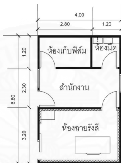
ภาพที่ 4.17 ภาพแสดงผังพื้นของห้องฉายรังสี
