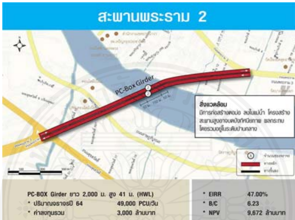
ภาพที่ 3.17 ภาพโครงการก่อสร้างสะพานพระรามสอง
