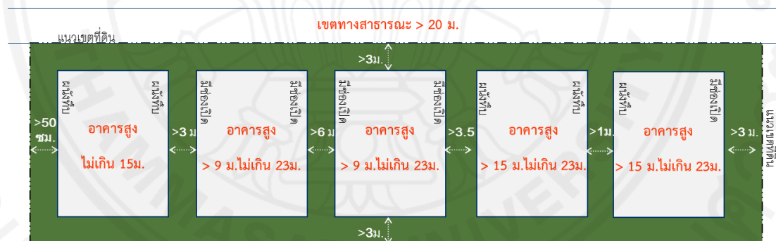
ภาพที่ 3.6 ระยะห่างอาคารของผนังอาคารที่มีช่องเปิดและผนังทึบ ภายในที่ดินเดียวกัน
