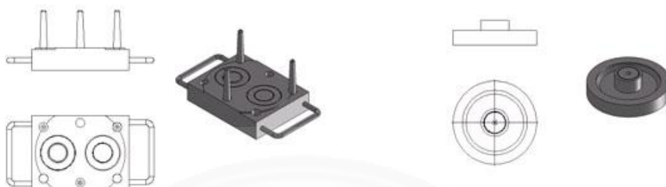
ภาพที่ 4.10 แม่พิมพ์แผ่นล่างก่อนและหลังออกแบบใหม่
