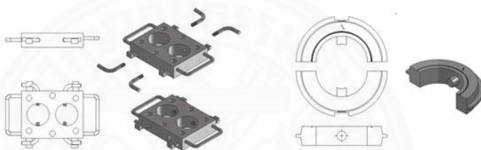
ภาพที่ 4.8 แม่พิมพ์แผ่นกลางก่อนและหลังออกแบบใหม่
