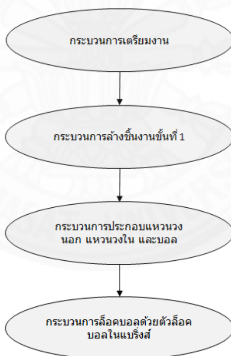
ภาพที่ 3.2 กระบวนการผลิตแบริ่งส์ช่วงหนึ่ง
