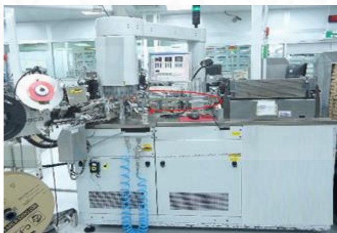
เครื่องจักรที่ทำงานเคลื่อนที่เป็นวงกลมในแนวระนาบ (Turret machine)
