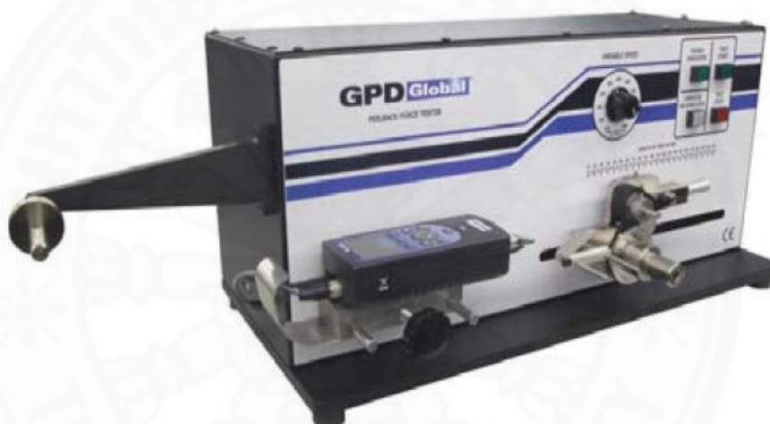
ภาพที่ ก.1 เครื่องมือที่ใช้ในการทดสอบค่าแรงดึงย้อนกลับของรอยขีด ที่มา: ข้อมูลจากบริษัทกรณีสึกษา (2558)
