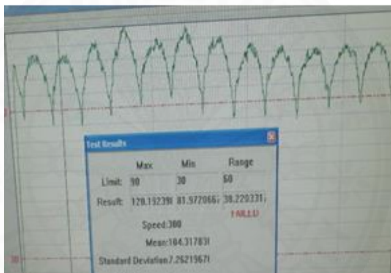
ภาพที่ 1.10 ตัวอย่าง Carrier Tape ความกว้าง 16 mm ที่มีค่าแรงดึงย้อนกลับไม่ผ่านข้อกำหนด ที่มา: ข้อมูลจากบริษัทกรณิศศึกษา (2558)
