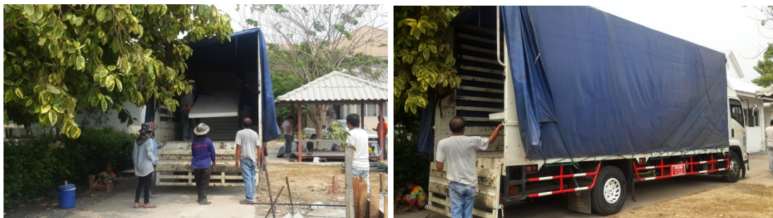
ภาพที่ 4.65 รถบรรทุก 6 ล้อที่ใช้ในการขนส่งแผ่นผนังฉนวนโครงสร้าง ของอาคารกรณีศึกษาที่ 5
