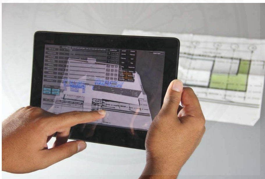
ภาพที่ 2.21 ตัวอย่างการใช้งานระบบดูตารางเวลาการก่อสร้าง จาก 4D Building Information Modelling with Augmented Reality on Mobile Devices to Support Construction Management (น.100) โดย Jay Vai, 2015.
