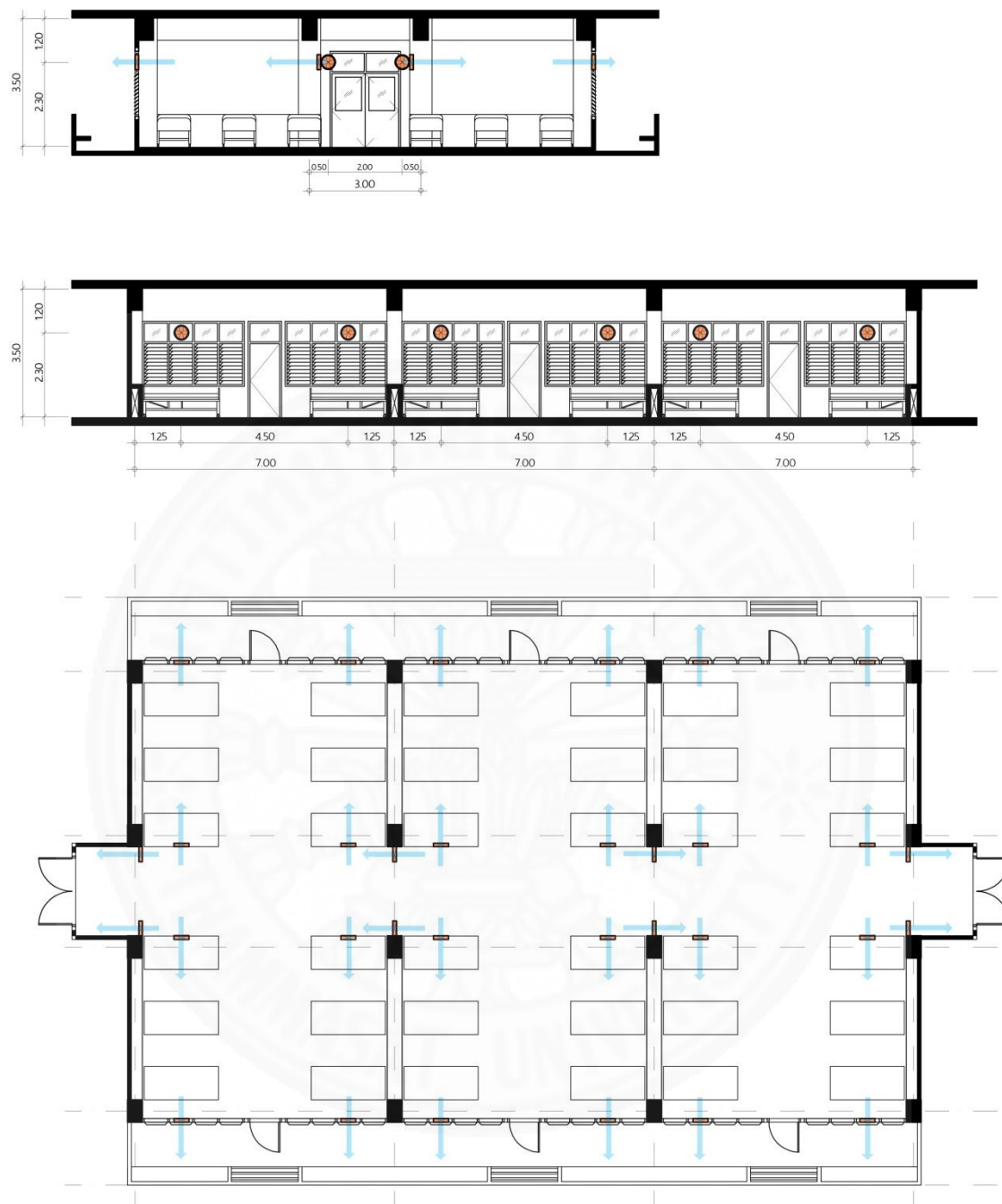
ภาพที่ 4.18 การระบายอากาศด้วยพัดลมประเภทใบพัด
