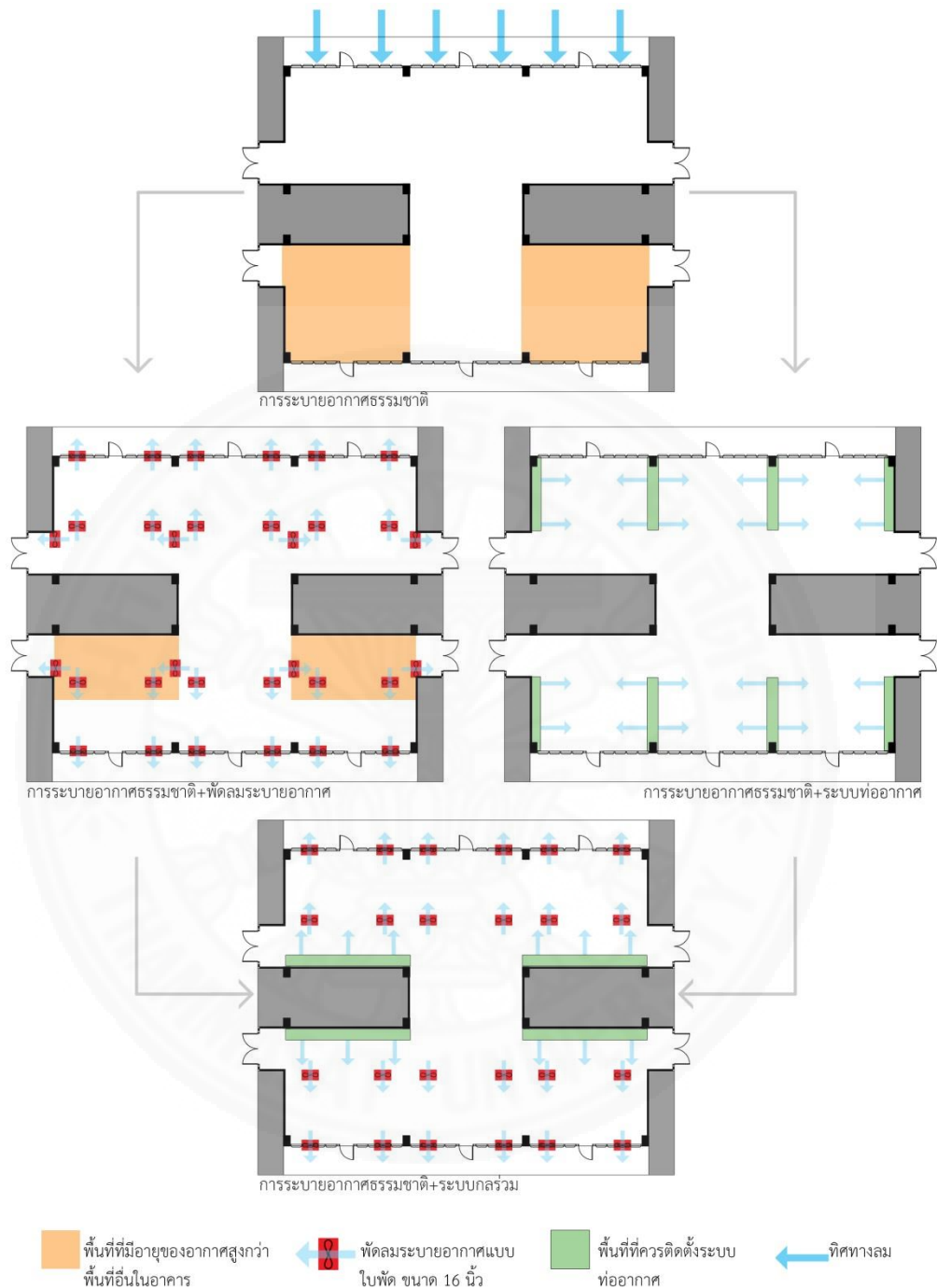
ภาพที่ 5.5 แนวทางติดตั้งระบบกลในผังอาคารสิ่งกีดขวางกึ่งกลาง
