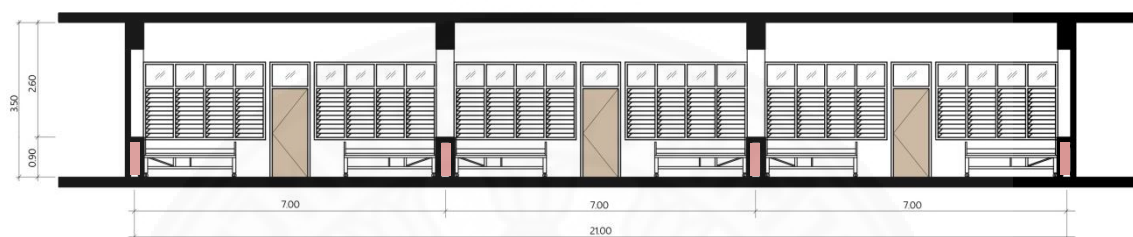
ภาพที่ 4.14 ตำแหน่งช่องท่องานระบบก๊าซและไฟฟ้าสำหรับผู้พิการ
