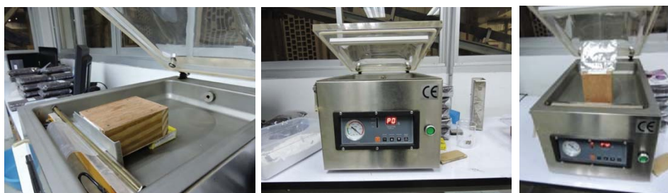
ภาพที่ 3.14 การทำบรรจุภัณฑ์ให้เป็นสุญญากาศ, จัดทำโดยผู้วิจัย เมื่อวันที่ 3 กุมภาพันธ์ 2559.
