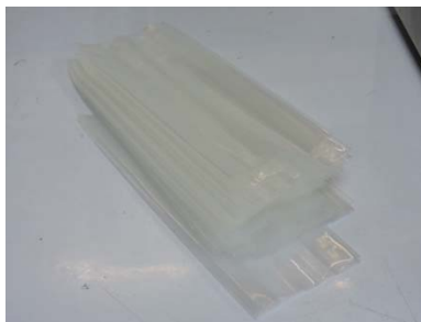
ภาพที่ 3.5 ถุงพลาสติกบรรจุสารเปลี่ยนสถานะขนาด 10.8 x 5 เซนติเมตร, จัดทำโดยผู้วิจัย เมื่อวันที่ 1 กุมภาพันธ์ 2559.
