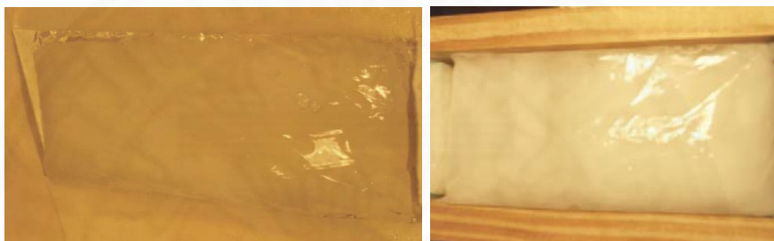
ภาพที่ 3.12 การบรรจุสารเปลี่ยนสถานะแบบไม่มีสุญญากาศ (ซ้าย) และการบรรจุสารเปลี่ยนสถานะแบบสุญญากาศ (ขวา), จัดทำโดยผู้วิจัย เมื่อวันที่ 21 มกราคม 2559.
