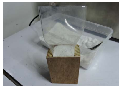
ภาพที่ 3.8 โครงแม่แบบสำหรับบรรจุสารเปลี่ยนสถานะ, จัดทำโดยผู้วิจัย เมื่อวันที่ 1 กุมภาพันธ์ 2559.
