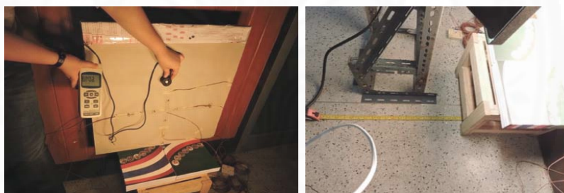
ภาพที่ 4.2 วิธีการวัดความเข้มรังสีดวงอาทิตย์กับผนังทดลอง, จัดทำโดยผู้วิจัย เมื่อวันที่ 1 กุมภาพันธ์ 2559.
