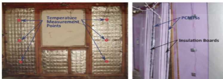
ภาพที่ 2.12 แผ่น PCM thermal shield (PCMTS) และรูปแบบการวางสารเปลี่ยนสถานะ, โดย Lee, et. al., 2015.
