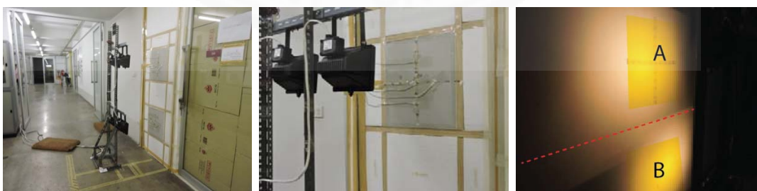
ภาพที่ 4.3 การจัดระยะดวงโคมไม่ให้แสงจากดวงโคมรบกวนกัน, จัดทำโดยผู้วิจัย เมื่อวันที่ 7 กุมภาพันธ์ 2559.
