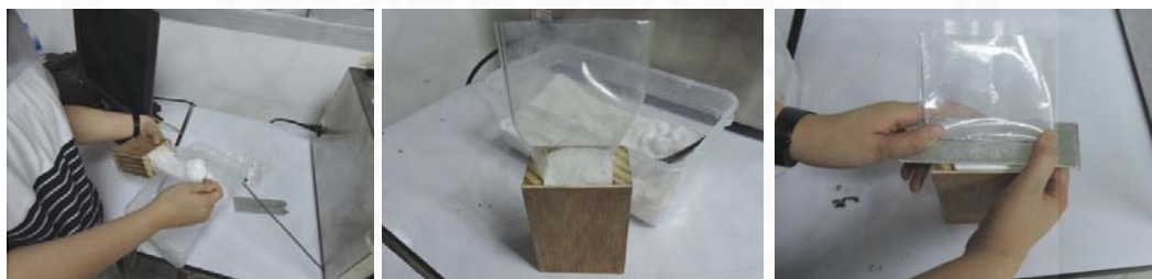
ภาพที่ 3.13 การบรรจุสารเปลี่ยนสถานะในแม่แบบ, จัดทำโดยผู้วิจัย เมื่อวันที่ 3 กุมภาพันธ์ 2559.
