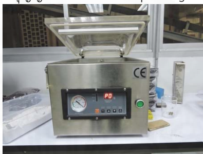
ภาพที่ 3.6 เครื่องบรรจุภัณฑ์แบบสุญญากาศ รุ่น VM 300 TE/A ยี่ห้อ packing machine, จัดทำโดยผู้วิจัย เมื่อวันที่ 1 กุมภาพันธ์ 2559.
