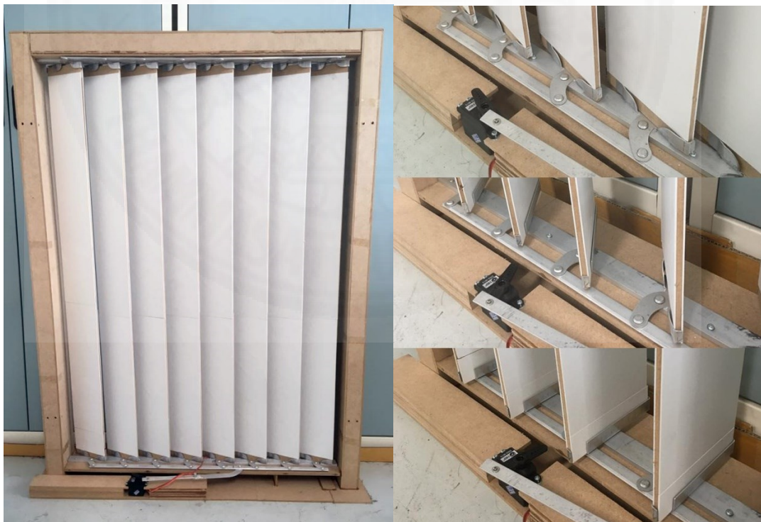
ภาพที่ 3.15 แบบจำลองบานเกล็ดปรับแสงอัตโนมัติ และลักษณะการเคลื่อนไหวของบานเกล็ด
