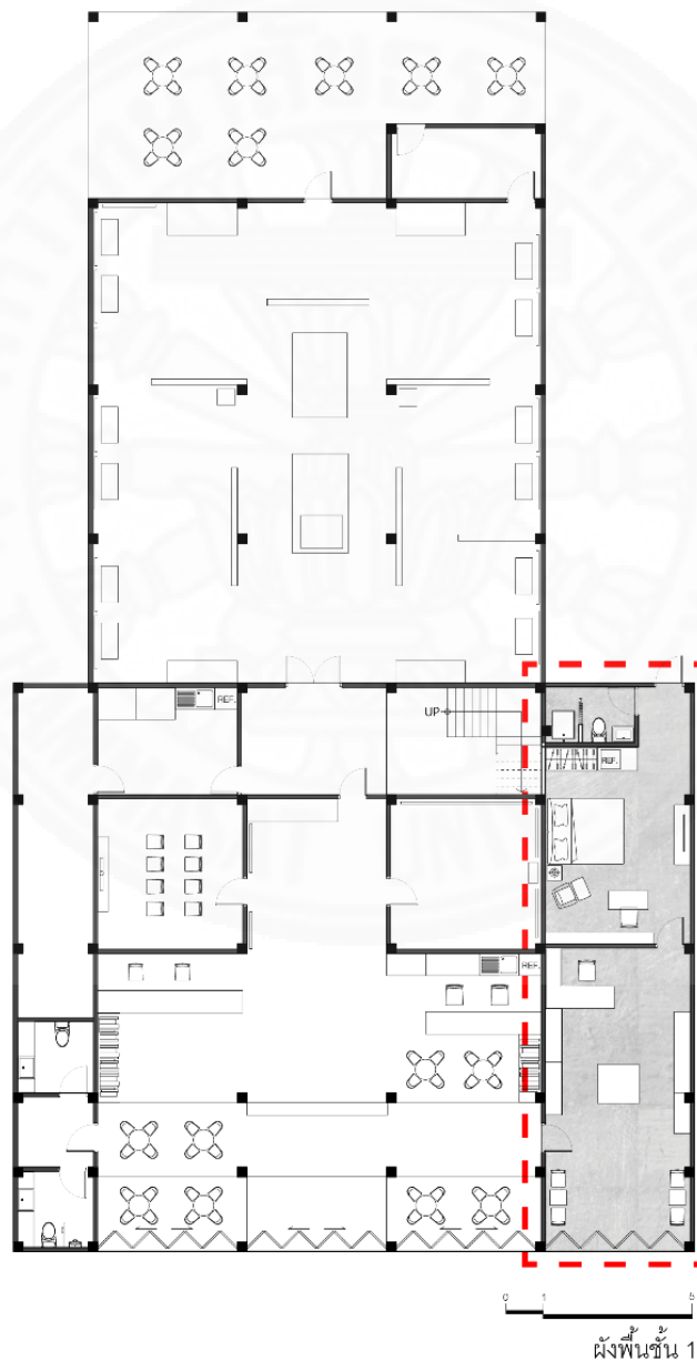
ภาพที่ 5.22 ตำแหน่งพื้นที่เปลี่ยนวัสดุจากพื้นกระเบื้องเป็นพื้นคอนกรีต. จาก ผู้วิจัย, 2559
