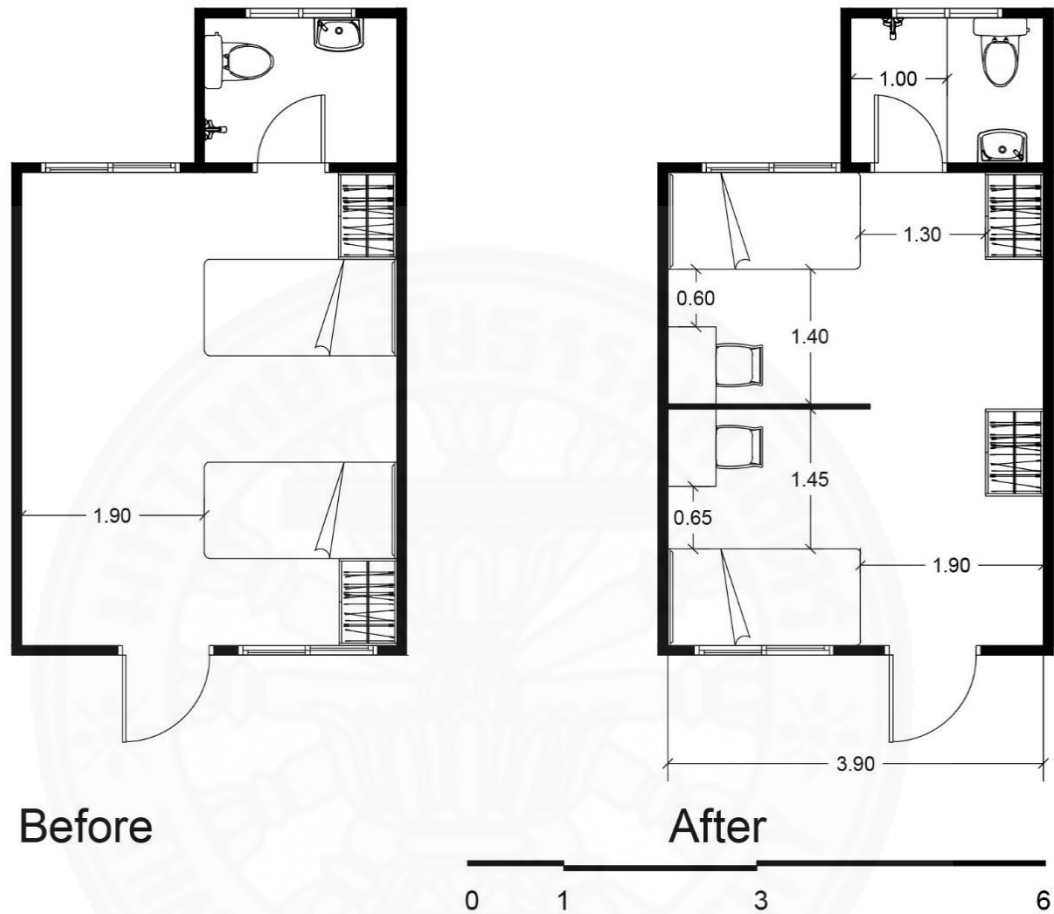
ภาพที่ 5.2 แปลนของห้องพัก M ก่อนและหลังการปรับปรุง โดยผู้วิจัย
