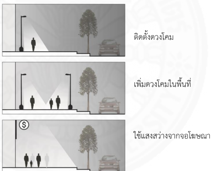
ภาพที่ 5.3 ตัวอย่างการเพิ่มแสงสว่างในพื้นที่
