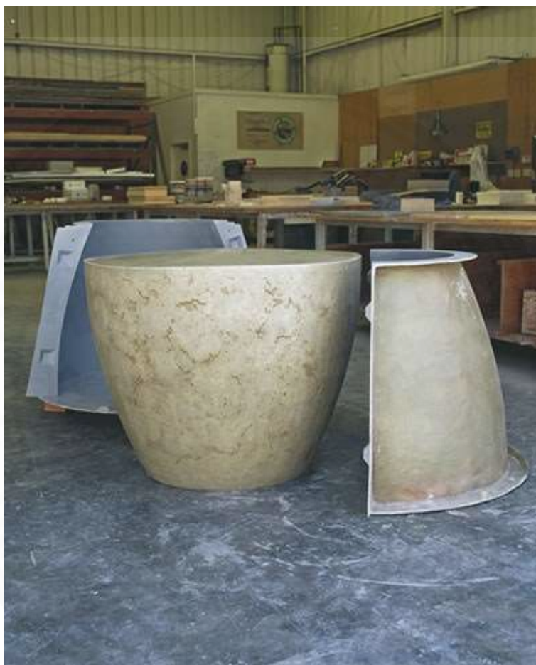
ภาพที่ 2.5 การหล่อขึ้นรูปสำเร็จชิ้นส่วนของอาคาร. จาก
