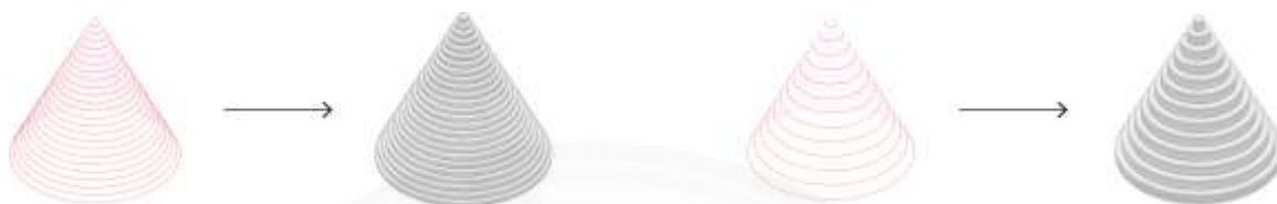
ภาพที่ 2.29 การขึ้นรูปโดยที่มีระยะระหว่างชั้นห่างกันน้อย (ซ้าย) และห่างกันมาก (ขวา). โดย ผู้วิจัย, 2559
