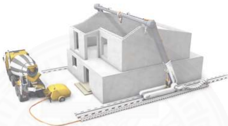
ภาพที่ ผ.11 แนวคิดการใช้เทคโนโลยีการพิมพ์สามมิติด้วยวัสดุซีเมนต์ ระบบ FDM ในการสร้างอาคารขนาดใหญ่. จาก http://www.craft-usc.com/wp-content/uploads/2014/07/New-Model-CC.png , 2015
