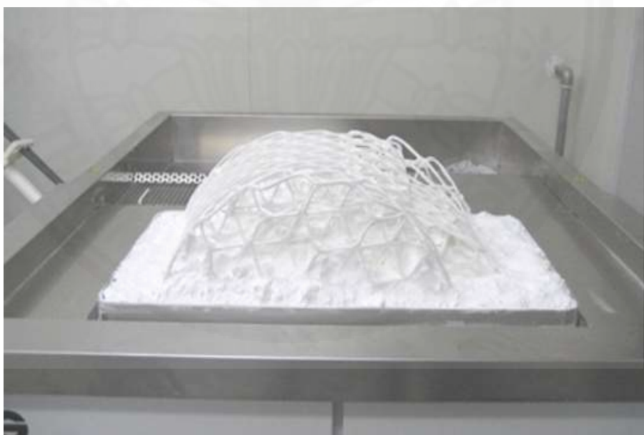
ภาพที่ ผ.4 การพิมพ์สามมิติระบบ SLS (Selective Laser Sintering). จาก http://www.kul3d.com/wp-content/uploads/2014/08/diamond-chair-1.jpg , 2014
