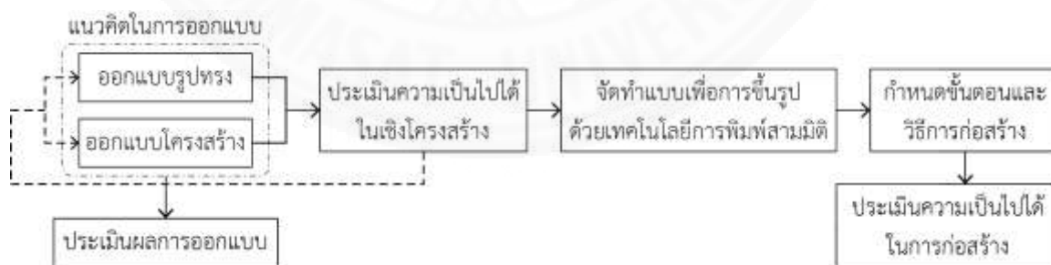
ภาพที่ 5.1 ขั้นตอนการศึกษาในกระบวนการออกแบบและก่อสร้าง. โดย ผู้วิจัย, 2559
