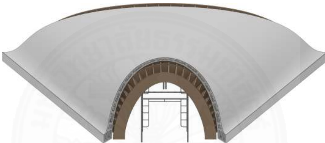
ภาพที่ 5.61 การทำระบบกันซึมให้กับผิวซีเมนต์ที่ฉาบปิดรอยต่อของชิ้นส่วน. โดย ผู้วิจัย, 2559
