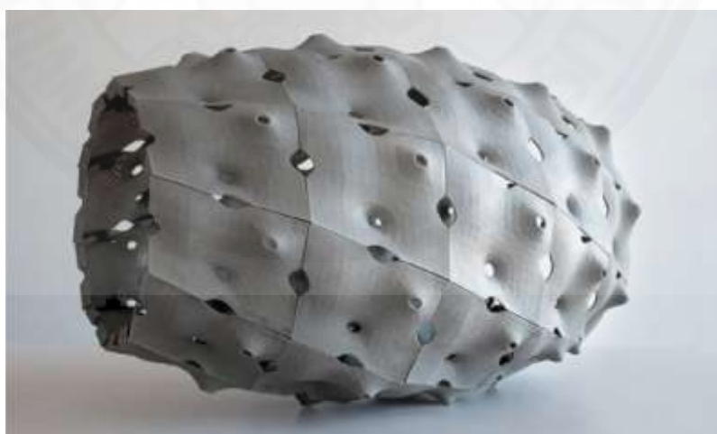
ภาพที่ 2.26 ตัวอย่างชิ้นงานซีเมนต์ที่ขึ้นรูปด้วยการพิมพ์ระบบ Powder Bed and Inkjet Head (SLS). จาก http://www.emergingobjects.com/wp-content/uploads/2013/01/drum1.jpg , 2013
