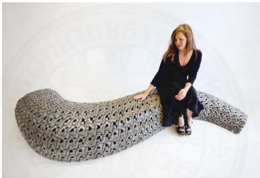
ภาพที่ ผ.13 ตัวอย่างชิ้นงานที่ขึ้นรูปด้วยการพิมพ์ระบบ SLS ของ Emerging Objects. จาก http://www.emergingobjects.com/wp-content/uploads/2011/12/SeatSlug1_LR1.jpg , 2013
