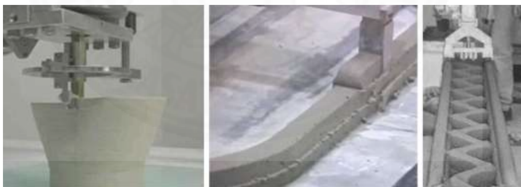
ภาพที่ ผ.12 การทำงานของเครื่องพิมพ์สามมิติระบบ FDM ของ Contour Crafting. จาก http://www.mapeng.net/Files/Remoteupload/2012-8/23/01-concrete-rapid-prototyping-contour-crafting-wall-structure.jpg , 2015
