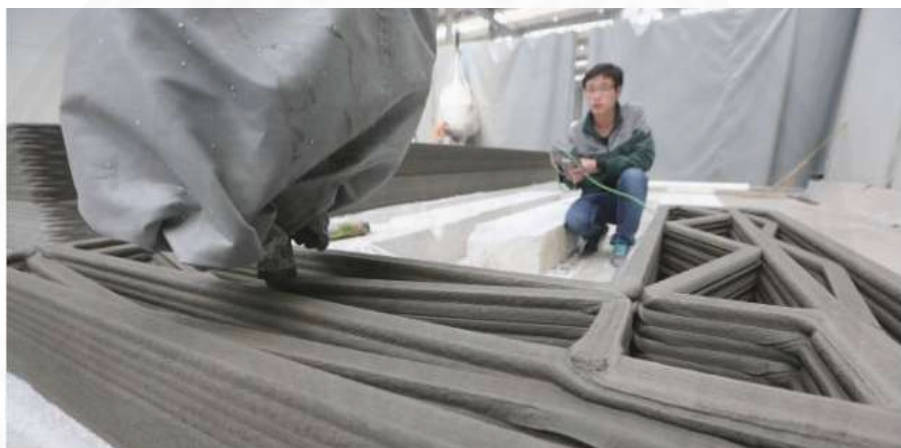
ภาพที่ ผ.17 การทำงานของเครื่องพิมพ์สามมิติระบบ FDM ของ WINSUN. จาก http://3dprinting.com/wp-content/uploads/2014/04/24.jpg , 2015
