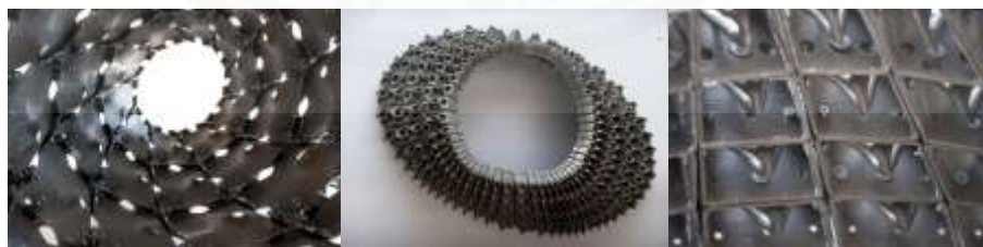
ภาพที่ ผ.14 ตัวอย่างชิ้นงานที่ขึ้นรูปด้วยการพิมพ์ระบบ SLS ของ Emerging Objects. จาก http://www.emergingobjects.com/projects/pantheon/ , 2013
