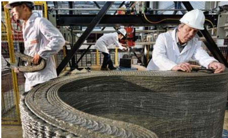
ภาพที่ ผ.9 ตัวอย่างชิ้นงานที่ขึ้นรูปด้วยการพิมพ์ระบบ FDM ของ Freeform Construction. จาก https://static-secure.guim.co.uk/sys-images/Guardian/Pix/pictures/2011/10/25/1319550165980/Freeform-construction-008.jpg , 2015
