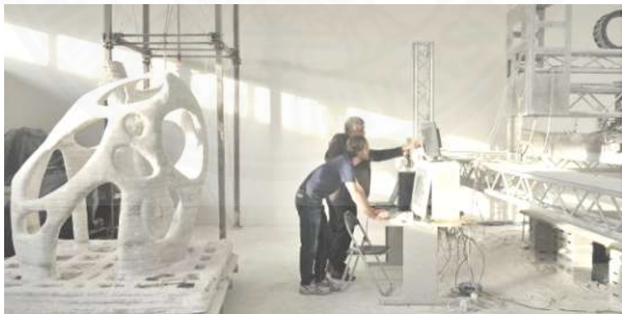
ภาพที่ ผ.7 ชิ้นงานต้นแบบที่ขึ้นรูปด้วยเครื่องพิมพ์สามมิติ D-Shape ในโรงงาน. จาก http://inhabitat.com/files/2010/03/printer3.jpg , 2010
