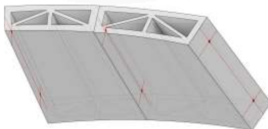
ภาพที่ 5.43 ตำแหน่งการเจาะรูที่ได้จากการระบุพิกัด. โดย ผู้วิจัย, 2559
