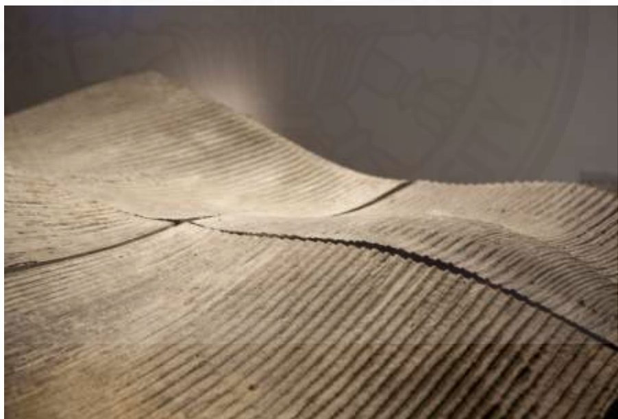
ภาพที่ ผ.10 ตัวอย่างชิ้นงานที่ขึ้นรูปด้วยการพิมพ์ระบบ FDM ของ Freeform Construction. จาก http://static.dezeen.com/uploads/2014/11/3D-printed-concrete-by-Foster-and-Partners_dezeen_468_1.jpg , 2015
