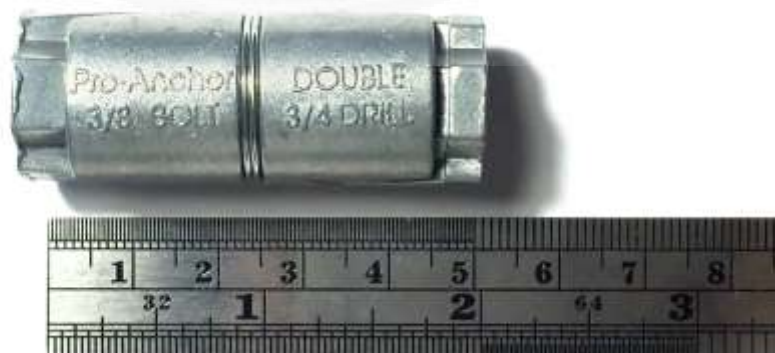
ภาพที่ 5.41 พุกกัลวาไนซ์ ขนาด 3/8". โดย ผู้วิจัย, 2559
