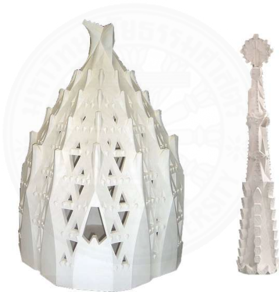
ภาพที่ ๘.5 ชิ้นงานต้นแบบของ Sagrada Familia ที่ขึ้นรูปด้วยเครื่องพิมพ์สามมิติ. จาก https://i.materialise.com/blog/wp-content/uploads/2015/03/print2.jpg , 2015
