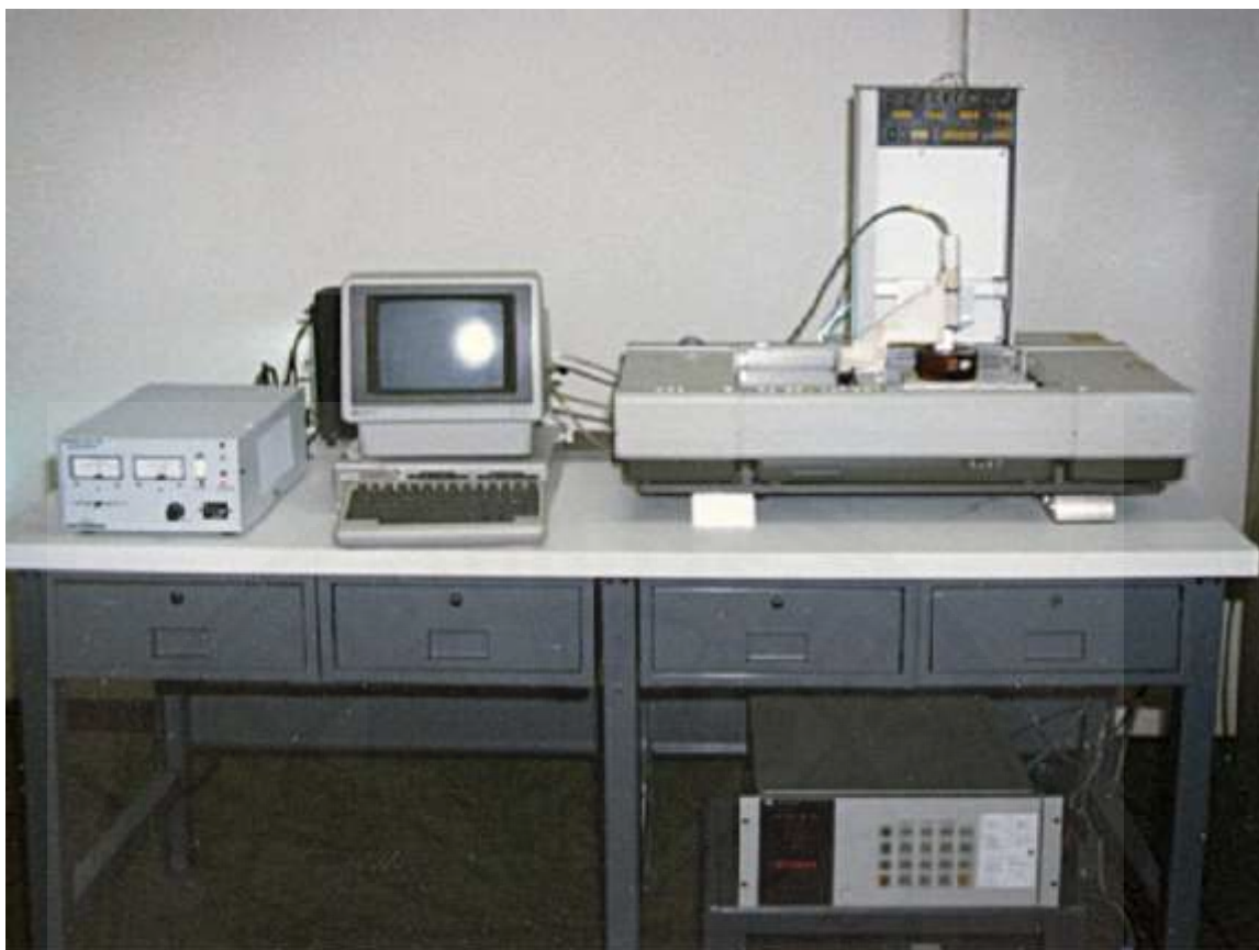
ภาพที่ ผ.2 เครื่องพิมพ์สามมิติแบบ stereolithography ต้นแบบของเครื่องพิมพ์สามมิติ. จาก http://3dprint.com/wp-content/uploads/2015/06/sla1g.jpg , 2015
