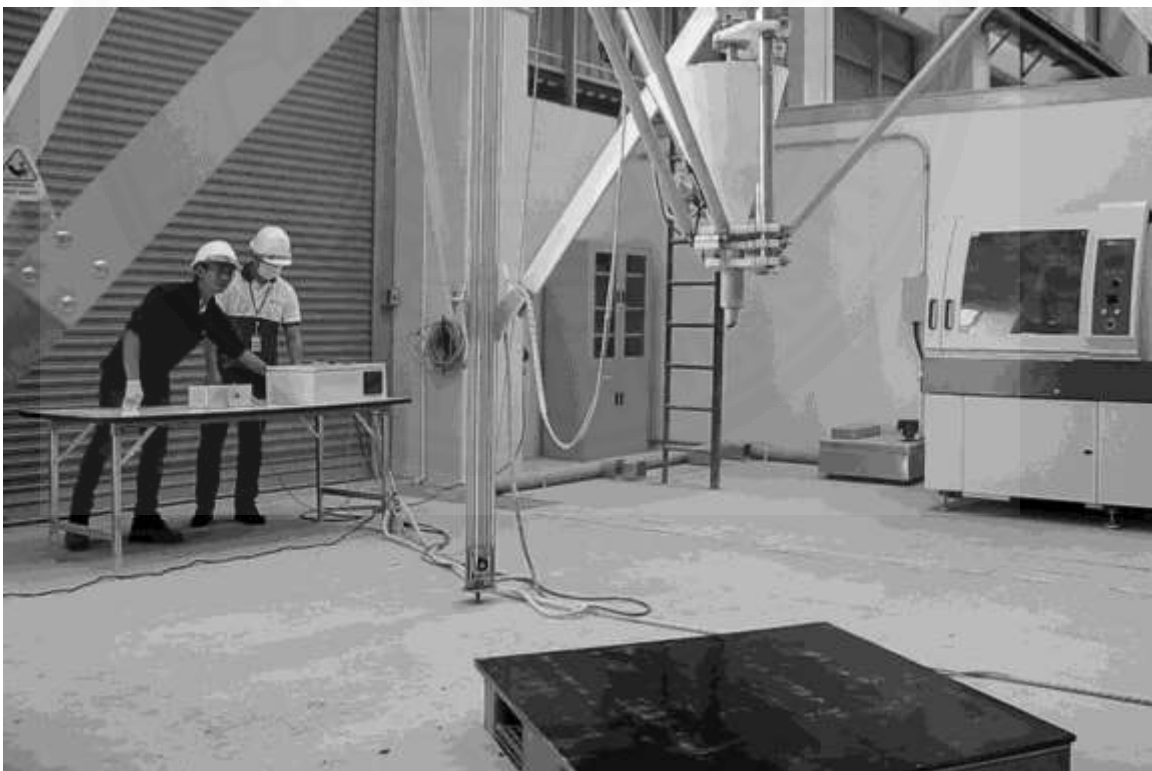
ภาพที่ ผ.25 เทคโนโลยีการพิมพ์สามมิติด้วยวัสดุซีเมนต์ระบบ FDM ของ SCG. จาก https://3dprint.com/131560/scg-3d-printable-cement/ , 2016
