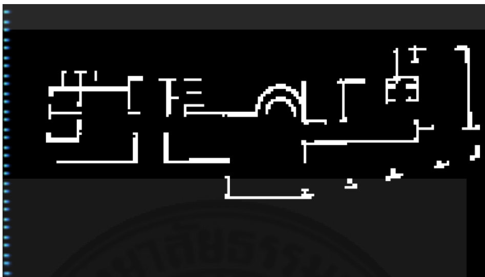
ภาพที่ 4.34 การแสดงผลเมื่อปรับค่า DETECT_INTENSITY เท่ากับ 35 หน่วย
