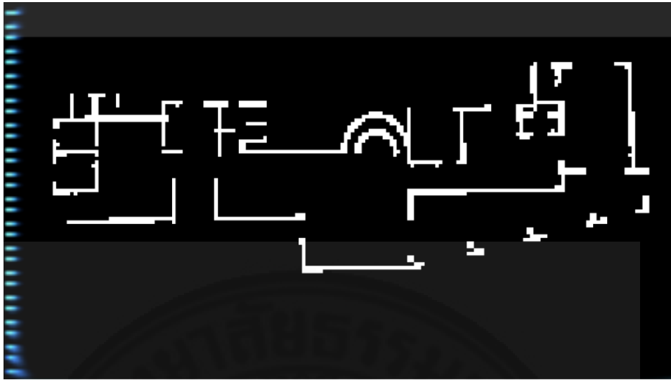
ภาพที่ 4.36 การแสดงผลเมื่อปรับค่า DETECT_INTENSITY เท่ากับ 50 หน่วย
