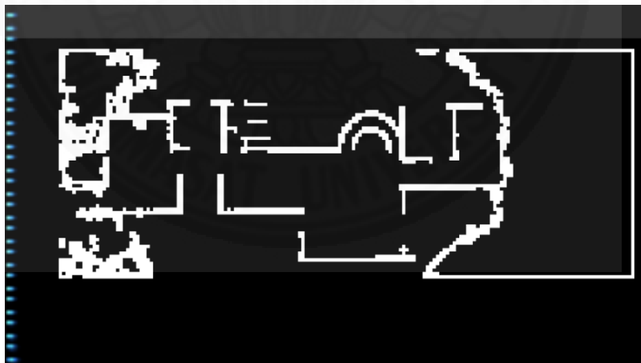
ภาพที่ 4.33 การแสดงผลเมื่อปรับค่า DETECT_INTENSITY เท่ากับ 50
