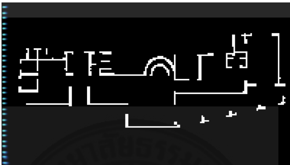
ภาพที่ 4.38 การแสดงผลเมื่อปรับค่า DETECT_INTENSITY เท่ากับ 50 หน่วย
