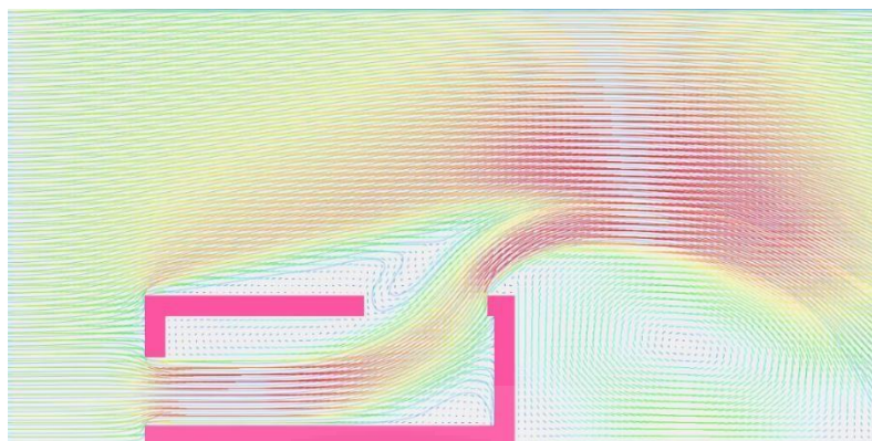
ภาพที่ 2.17 การจำลองสถานการณ์อากาศไหลผ่าน ผนังอาคาร แสดงผลเป็นเส้นและสี จาก architecturalecologies , 2010
