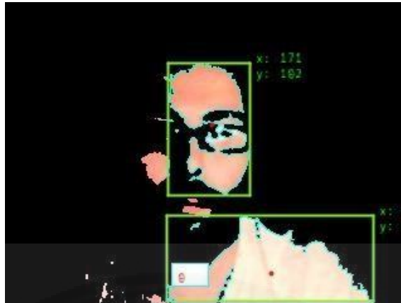
ภาพที่ 2.13 การตรวจจับกลุ่มพิกเซลของคน โดย Library Blob Detection ของ Processing จาก https://sites.google.com/site/blobscanner , 2012
