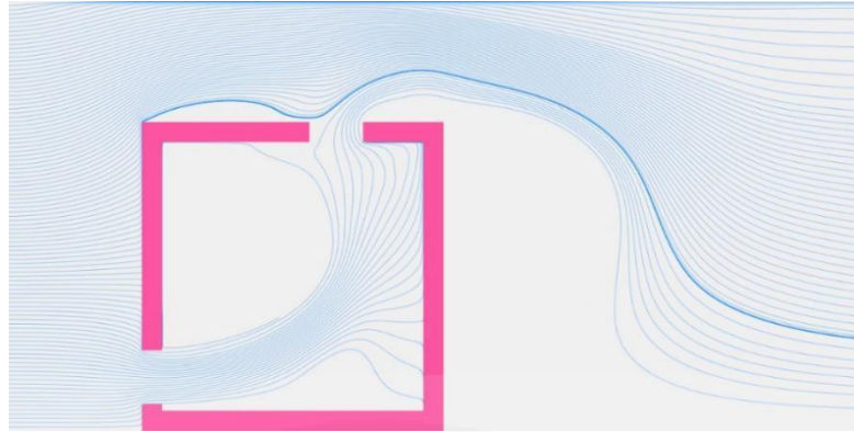
ภาพที่ 2.15 การจำลองสถานการณ์อากาศไหลผ่าน ผนังอาคาร แสดงผลเป็นเส้น จาก architecturalecologies, 2010
