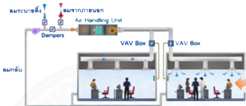
ภาพที่ 4.10 แสดงระบบปริมาณลมจ่ายแปรเปลี่ยน (Variable Air Volume)
