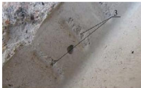
ภาพที่ 2.43 ลักษณะการวิบัติที่ขอบของ keys พบคอนกรีตถูกบีบอัดจนแตกออกมาเนื่องจาก หน่วยแรงอัดเฉพาะที่เมื่อพิจารณาส่วนที่เป็นคอนกรีต
