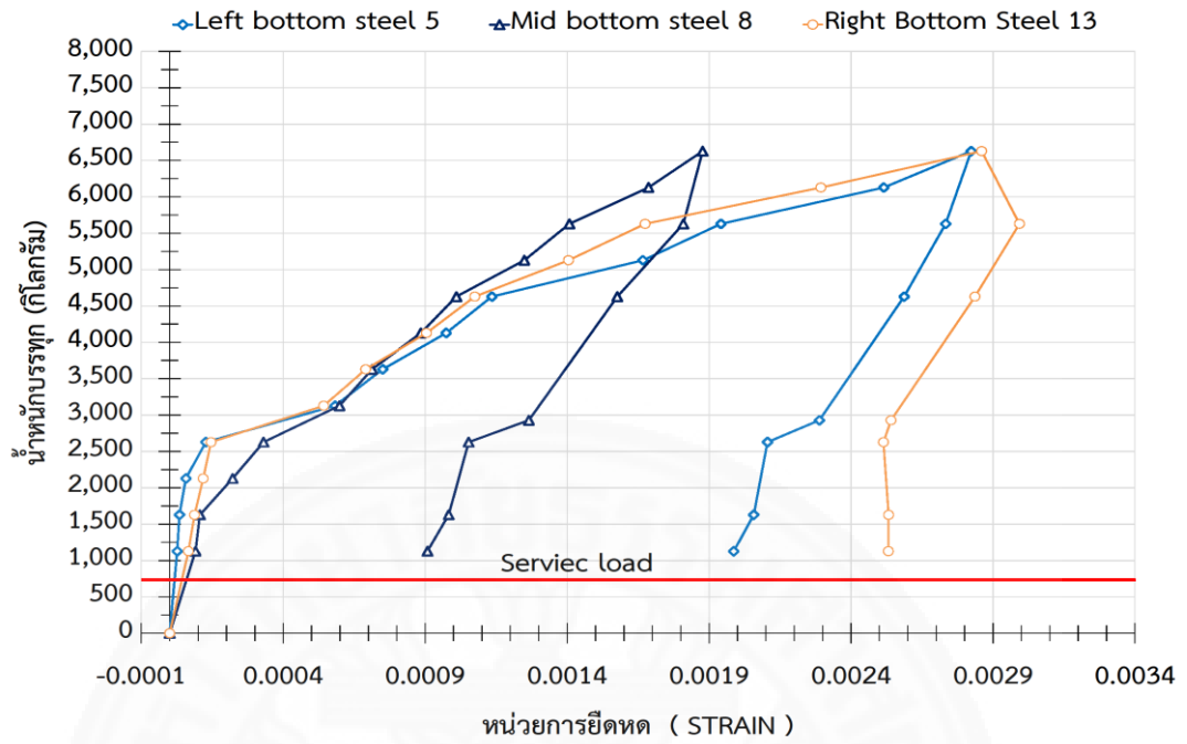
ภาพที่ 5.53 ความสัมพันธ์ระหว่างน้ำหนักบรรทุกกับหน่วยการยืดหด (Strain) ที่ต้องลอนของแผ่นเหล็ก ในตัวอย่างทดสอบแบบที่ 6 (SF-2m)
