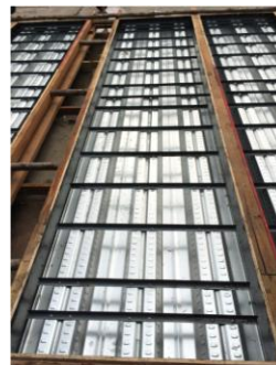
ภาพที่ 4.16 การติดตั้งอุปกรณ์ต้านแรงเฉือนสำหรับตัวอย่างทดสอบแบบที่ 4 (SF-4m)
