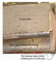
ภาพที่ 2.47 การไถลแยก (End Slip) ระหว่างแผ่นเหล็กกริดลอนกับคอนกรีตบริเวณปลายแผ่น ตัวอย่างทดสอบ
