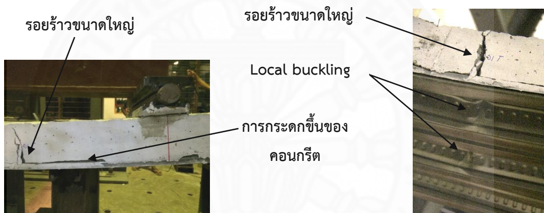
ภาพที่ 5.7 รอยร้าวขนาดใหญ่ที่ทำให้เกิดการแอ่นตัวทันทีทันใดครั้งที่ 2 ในตัวอย่างทดสอบควบคุมแบบที่ 1 (SN-4m)
