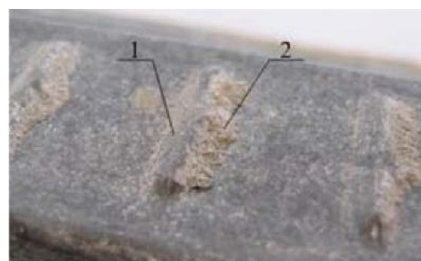
ภาพที่ 2.42 ลักษณะการวิบัติที่ขอบของ key พบคอนกรีตถูกบีบอัดจนแตกออกมาเนื่องจาก หน่วยแรงอัดเฉพาะที่ เมื่อพิจารณาส่วนที่เป็นลอนของแผ่นเหล็กโรลลอน
