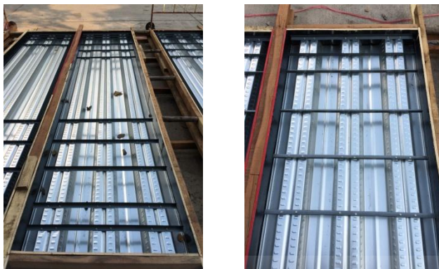
ภาพที่ 4.14 การติดตั้งอุปกรณ์ด้านแรงเฉือนสำหรับตัวอย่างทดสอบแบบที่3 (SS-4m)
