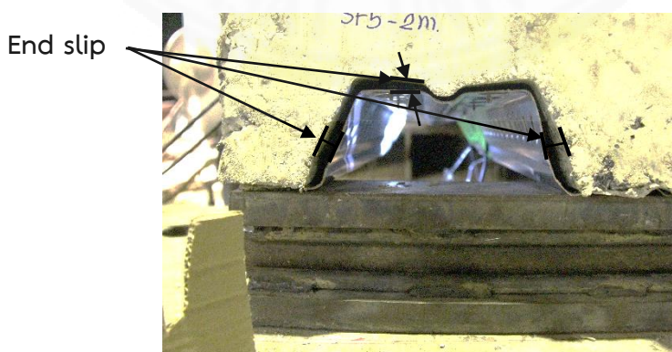
ภาพที่ 5.55 การไถลแยกที่ปลายแผ่นพื้น (End Slip) หลังจากวิบัติ ในตัวอย่างทดสอบแบบที่ 6 (SF-2m)
