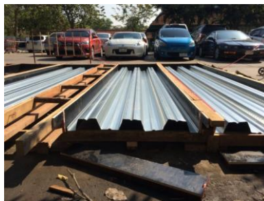
ภาพที่ 4.16 การติดตั้งอุปกรณ์ต้านแรงเฉือนสำหรับตัวอย่างทดสอบแบบที่ 4 (SF-4m)
