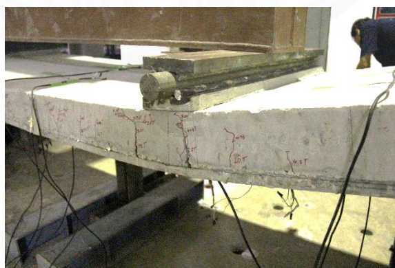
ภาพที่ 5.64 การหักของแผ่นพื้นที่รอยร้าวขนาดใหญ่ ในตัวอย่างทดสอบแบบที่ 7 (SFR-4m)
