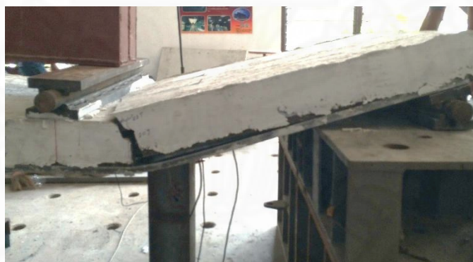
ภาพที่ 5.26 การหักของแผ่นพื้นที่บริเวณรอยร้าวขนาดใหญ่ซึ่งอยู่ในช่วง b+2t ในตัวอย่างทดสอบแบบที่ 3 (SS-4m)
