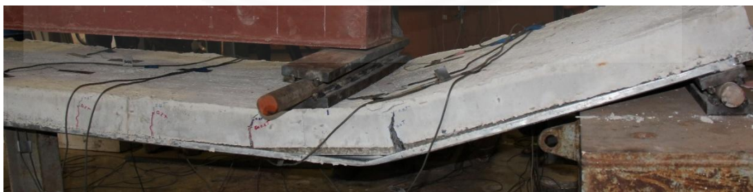
ภาพที่ 5.39 การหักของแผ่นพื้นที่รอยร้าวขนาดใหญ่ ในตัวอย่างทดสอบแบบที่ 4 (SF-4m)
