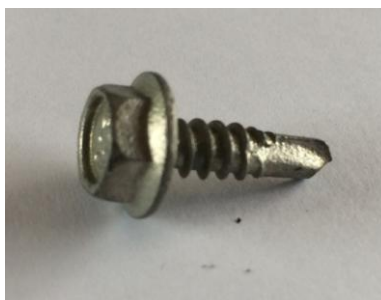
ภาพที่ 4.3 สกรูที่ใช้ในการยึดเหล็กฉาก กับแผ่นเหล็กรีดลอน
