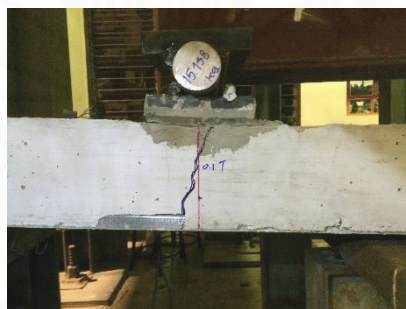
ภาพที่ 5.6 รอยร้าวขนาดใหญ่ได้จุดให้น้ำหนักบรรทุกที่ทำให้เกิดการแอ่นตัวทันทีทันใดครั้งที่ 1 ในตัวอย่างทดสอบควบคุมแบบที่ 1 (SN-4m)
