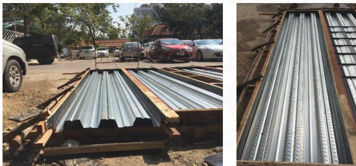
ภาพที่ 4.9 แผ่นเหล็กกรีดลอนสำหรับ ตัวอย่างทดสอบควบคุมแบบที่1 (SN-4m)
