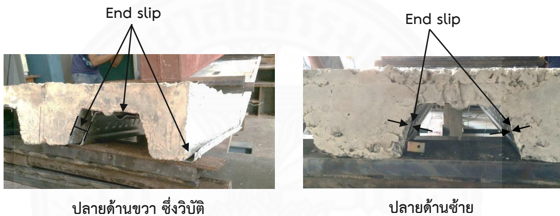
ภาพที่ 5.28 การไถลแยกที่ปลายแผ่นพื้น (End Slip) หลังจากวิบัติ ในตัวอย่างทดสอบแบบที่ 3 (SS-4m)
