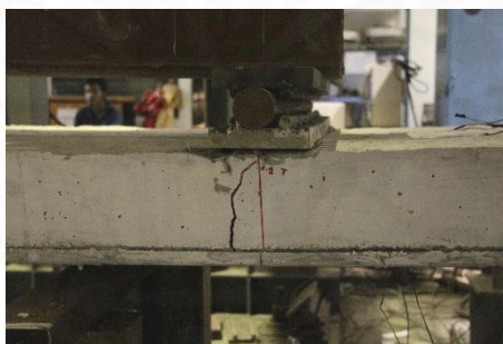
ภาพที่ 5.15 รอยร้าวขนาดใหญ่ที่ทำให้เกิดการแอ่นตัวทันทีทันใดครั้งที่ 1 ในตัวอย่างทดสอบแบบที่ 2 (SM-4m)
