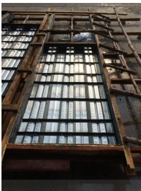
ภาพที่ 4.20 การติดตั้งอุปกรณ์ด้านแรงเฉือนสำหรับตัวอย่างทดสอบแบบที่6 (SF-2m)
