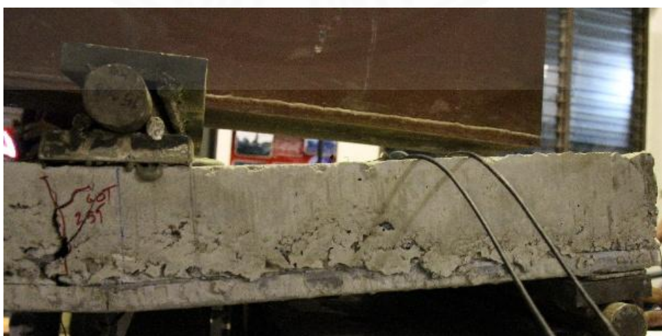
ภาพที่ 5.56 การหักของแผ่นพื้นที่รอยร้าวขนาดใหญ่ ในตัวอย่างทดสอบแบบที่ 6 (SF-2m)
