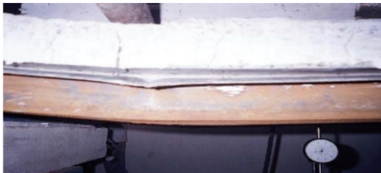
ภาพที่ 2.61 ลักษณะการวิบัติของแผ่นพื้นคอมโพสิตที่ไม่ได้เสริม Shear Connectors การวิบัติเกิดจากการเสี้ยกำลังยึดเหนี่ยว และเกิดการไถลแยกระหว่างแผ่นเหล็กที่ลอนกับคอนกรีตที่ปลายแผ่นพื้นคอมโพสิต
