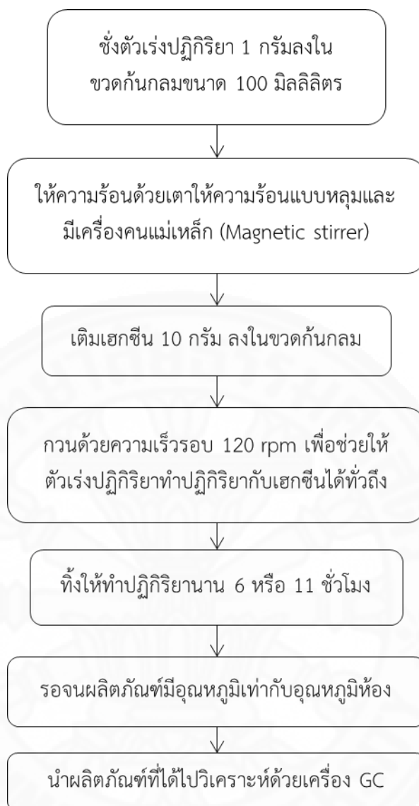
ภาพที่ 3.1 กระบวนการทดลองปฏิกิริยาโอลิโกเมโรเซชันบนตัวเร่งปฏิกิริยา
