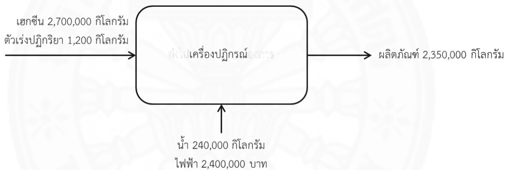
ภาพที่ 4.6 สมดุลมวลของการผลิตเชื้อเพลิงจากกระบวนการโอลิโกเมอไรเซชันเอทิลีนโดยใช้เครื่องปฏิกรณ์แบบเบตนิ่ง (โครงการที่ 2)
