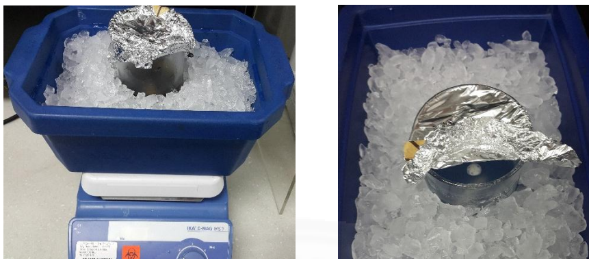
ภาพผนวกที่ จ.17 การตักตะกอนอิมมูโนโกลบูลิน ด้วยแอมโมเนียมซัลเฟตอิ่มตัว
