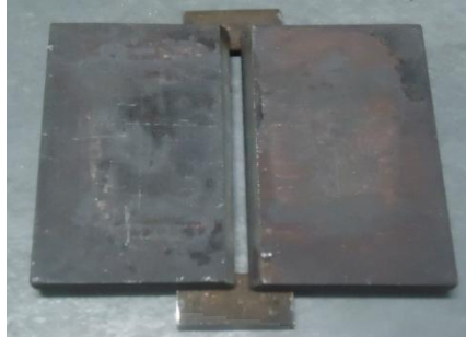
ภาพที่ 3.1 ชิ้นงานทดสอบเหล็กกล้าเครื่องมืองานร้อน SKD 61
