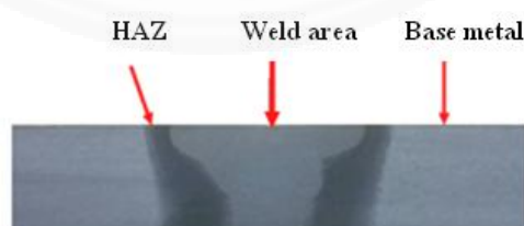
ภาพที่ 4.3 ชิ้นงาน (HT/Temp.) เชื่อมแบบ Spray transfer (กระแส 150 A อัตราการไหลของแก๊ส 13 L/min)
