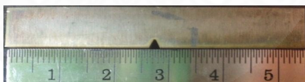
ภาพที่ 4.43 ชิ้นงานทดสอบแรงกระแทกรอยบากกลางแนวเชื่อมตามมาตรฐาน ASTM A370
