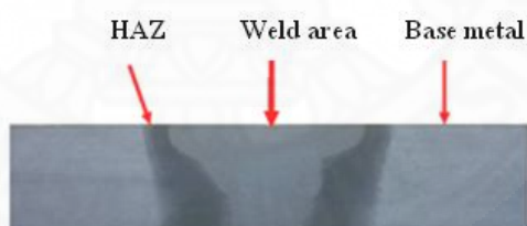
ภาพที่ 4.2 ชิ้นงาน (HT/Temp.) เชื่อมแบบ Pulsed Spray transfer (กระแส 190 A อัตราการไหลของแก๊ส 13 L/min)
