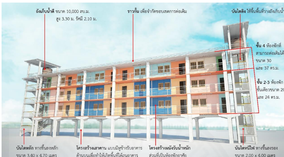
ภาพที่ 5.22 โครงสร้างและการใช้งานของอาคาร. โดยผู้วิจัย วันที่ 25 พฤศจิกายน 2559.
