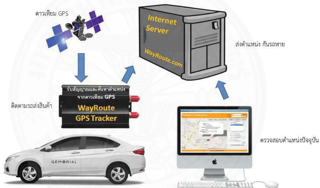
ภาพที่ 5.4 ระบบการทำงาน GPS ของรถยนต์รับ-ส่งสินค้า
