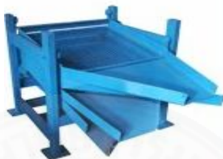
ภาพที่ 6.6 แสดงเครื่องคัดเมล็ดมะขาม และกลไกการคัดเลือก
