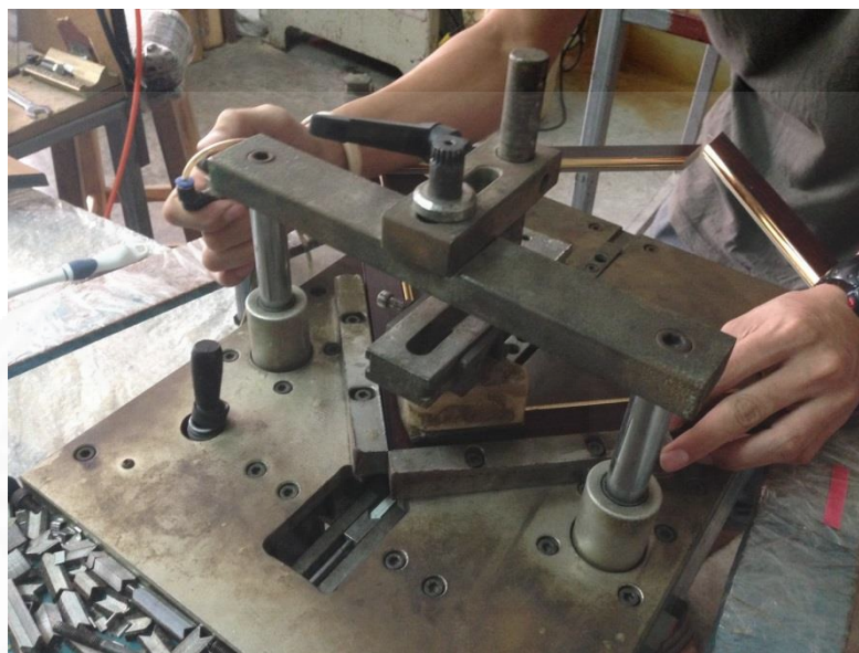
ภาพที่ 1.5 ขั้นตอนการเย็บมุมหลังกรอบรูป
