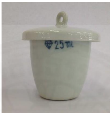
ภาพที่ 3.8 ถ้วยครุชชีเบิลพร้อมฝาปิดที่ใช้เป็นเครื่องปฏิกิริยาสำหรับงานวิจัย
