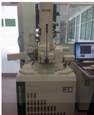
ภาพที่ 3.12 กล้องจุลทรรศน์อิเล็กตรอนแบบส่องกราด (SEM)
