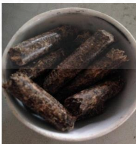
ภาพที่ 3.1 ตัวอย่างขยะชุมชนอัดแท่งที่ใช้ในงานวิจัย
