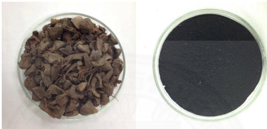
ภาพที่ 3.4 กะลาปาล์มก่อนและหลังทำเป็นผงถ่าน
