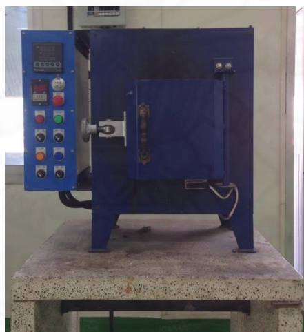
ภาพที่ 3.10 เตาเผาไฟฟ้าอุณหภูมิสูง (muffle furnace)
