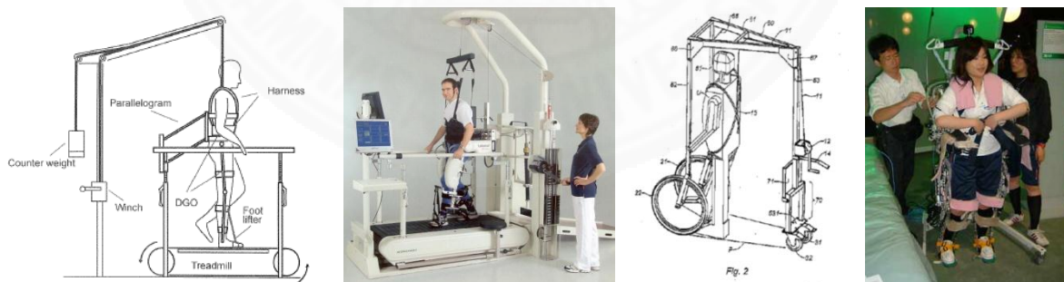
ภาพที่ 2.21 การยกตัวโดยใช้รอกดึงขึ้นในแนวตั้งฉากกับพื้นและใช้น้ำหนักถ่วงฝั่งตรงข้าม
