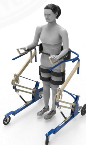
ภาพที่ 5.4 ส่วนของราวมือจับ และการยึดคนกับวอล์คเกอร์
