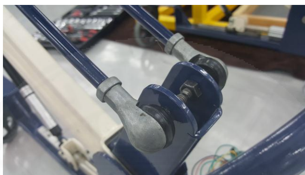
ภาพที่ 5.5 จุดหมุน บริเวณที่ใช้ลูกปืนตาเหล็กในการยึด
