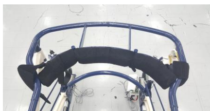
ภาพที่ 5.4 ส่วนของราวมือจับ และการยึดคนกับวอล์คเกอร์
