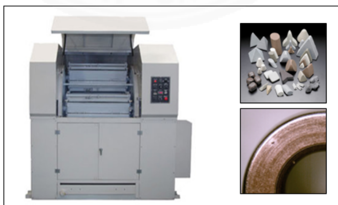
ภาพที่ 3.3 ลักษณะเครื่องขัดผิวชิ้นงานและหินขัด ที่ใช้ในกระบวนการลบคมของชิ้นงาน
