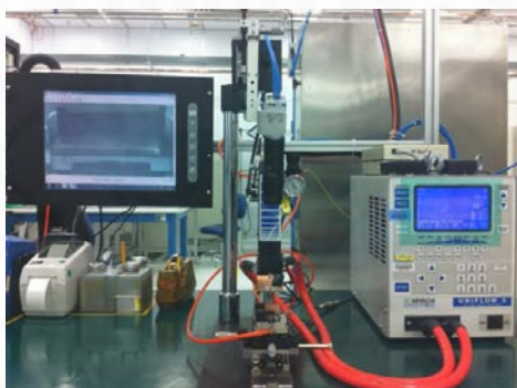
ภาพที่ 1.4 เครื่องมือสำหรับการติดแผ่นวงจรพิมพ์แบบยึดหยุ่นกับตัวชิ้นงาน
