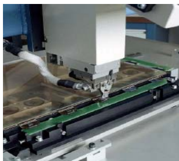
ภาพที่ 2.10 ช่วงบัดกรีอ่อน
