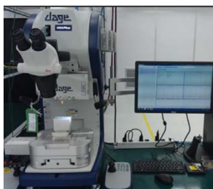
ภาพที่ 1.5 เครื่องมือ Peel test machine ในการทดสอบค่าความแข็งแรงของการยึดติดแบบดึงลอก
