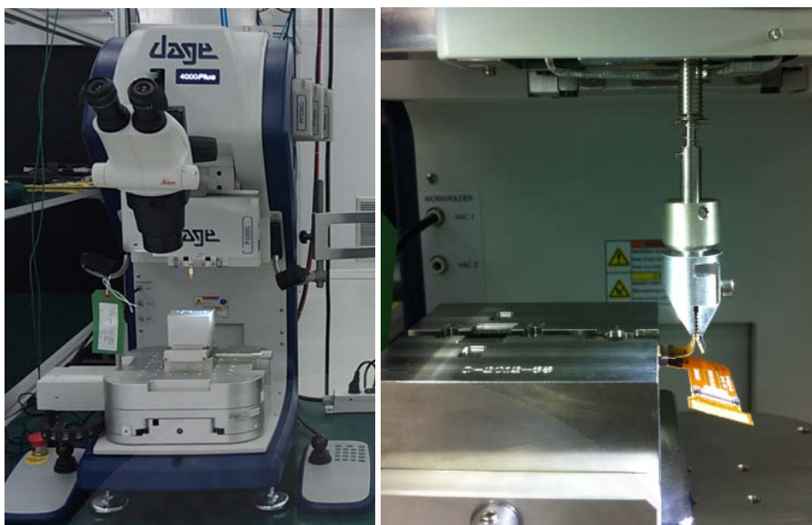
ภาพที่ 3.5 เครื่องวัดค่าความแข็งแรงของการยึดติดแบบดึงลอก (Peel Strength) และวิธีการทดสอบ
