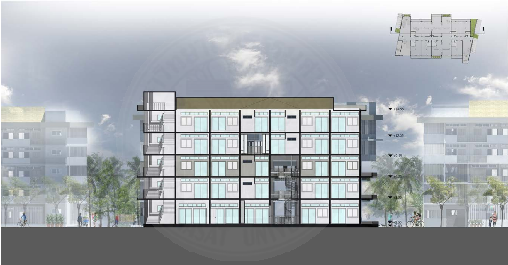
ภาพที่ 5.26 รูปตัดแนวยาวของอาคารต้นแบบโครงการที่พักอาศัยสำหรับผู้มีรายได้น้อยที่มีพื้นที่ส่วนกลางร่วมกัน
