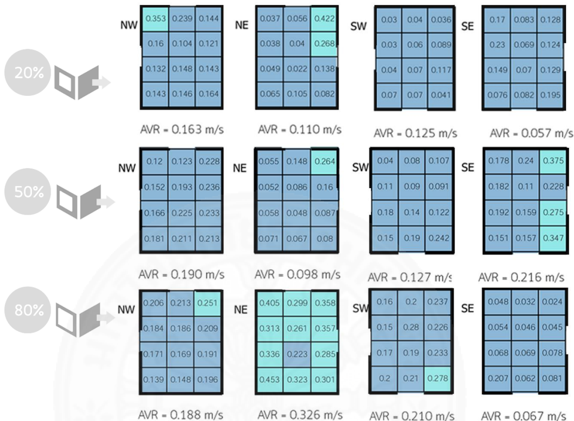
ภาพที่ 4.18 ผลการทดลองสำหรับรูปแบบช่องเปิดสองด้านแบบเอียงกัน WWR20,50 และ80 โดยเป็นหน่วยพักอาศัยประเภทห้องพักขนาดกว้าง 1.00 เมตร ยาว 1.25 เมตร และสูง 2.60 เมตร โดย ผู้วิจัย ,2560
