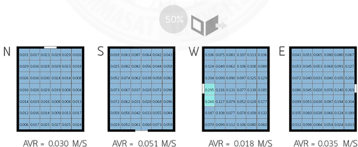
ภาพที่ 4.28 ผลการทดลองสำหรับรูปแบบช่องเปิดแบบด้าน เดียว WVR50 โดยเป็นหน่วยพักอาศัยประเภททาวน์เฮ้าส์ขนาดกว้าง 4.00 เมตร ยาว 6.0 เมตร และสูง 2.60 เมตร โดย ผู้วิจัย ,2560
